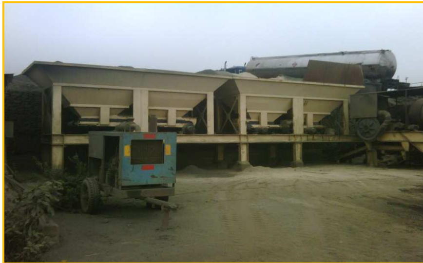
Fotografía #8 Muestra las cuatro tolvas de agregados que posee la planta de asfalto
