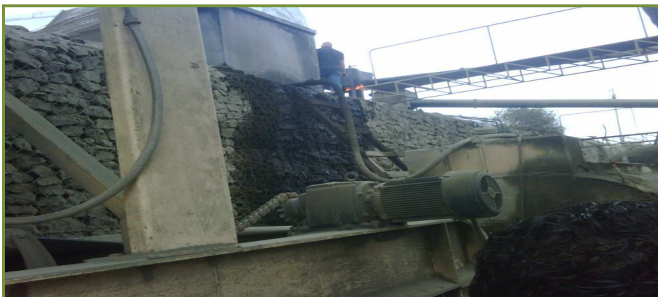
Fotografía #7. Muestra el derrame que se produce al momento de la descargar Cemento Asfálticos
