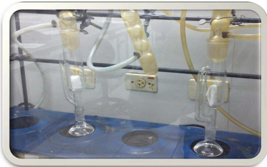
**Figura 3.29.- Extracción del aceite de maní por método de Soxhlet**
