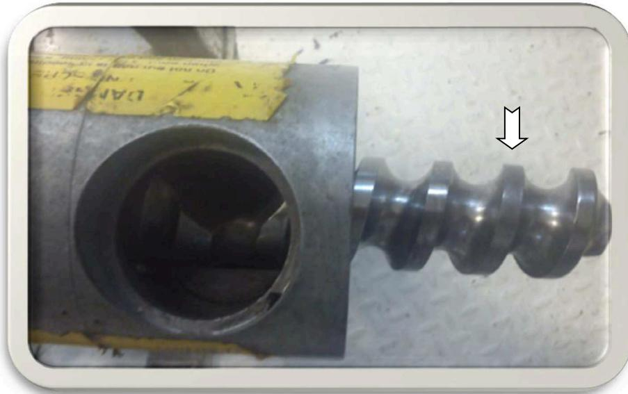
3.3.- Luego se emperna el soporte del tornillo sin fin junto con la resistencia
