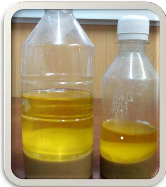
5.-Luego se procede a la separación (aceite – pasta) utilizando una bomba de vacío, papel filtro, el quitosato y el embudo para filtro al vacío.
