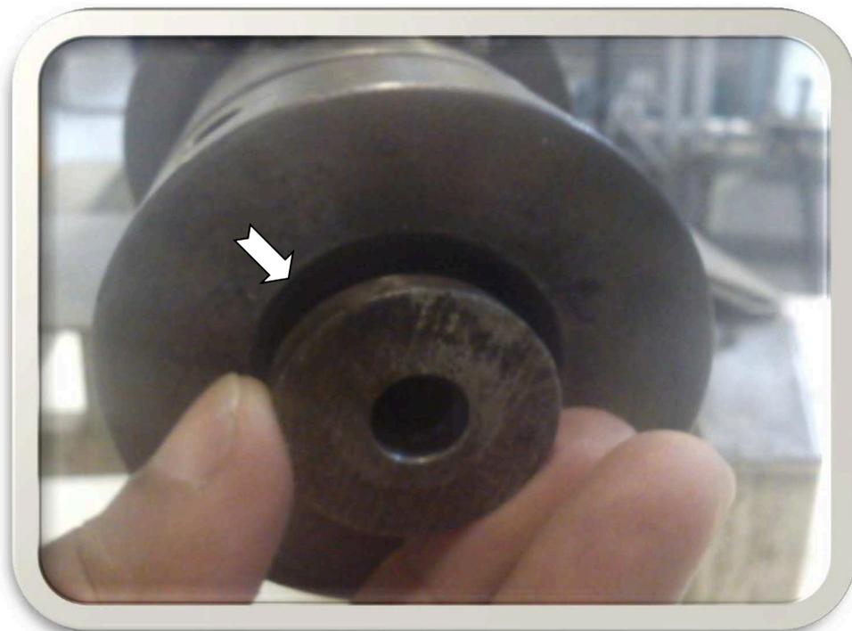
3.6.- Existen algunas placas orificios con diferentes medidas, para esta extracción se utilizo una placa orificio con una abertura de 12 mm para la salida final del sub-producto, pasta de mani.
