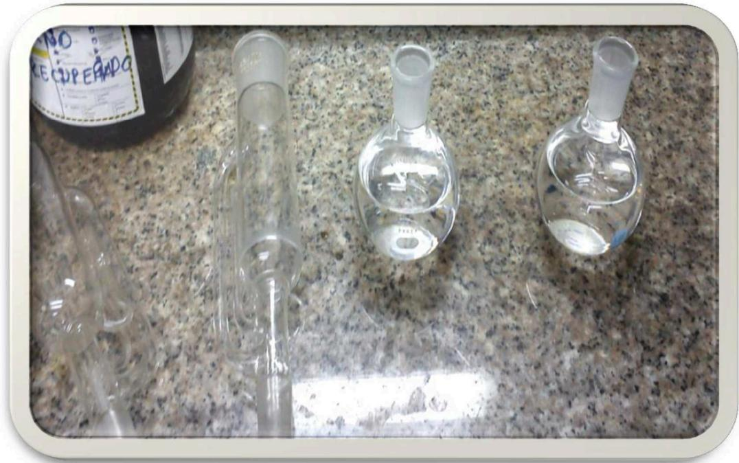
**Figura 3.28.- Extracción del aceite de maní por método de Soxhlet**
