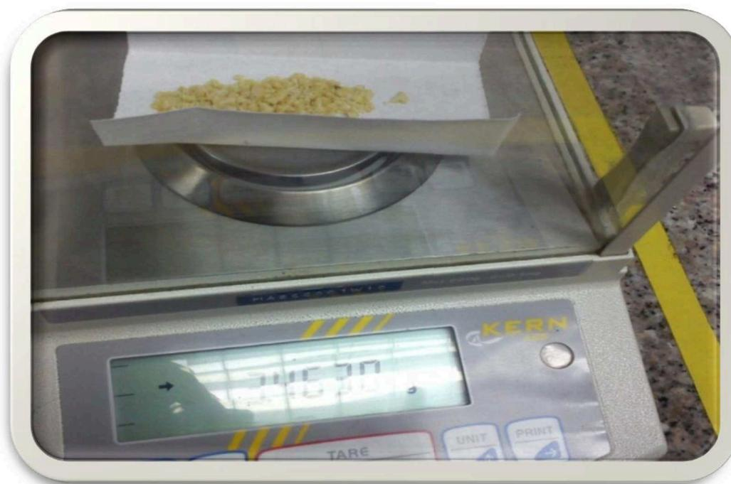
Figura 3.24.- Preparación de la muestra previo a la extracción
