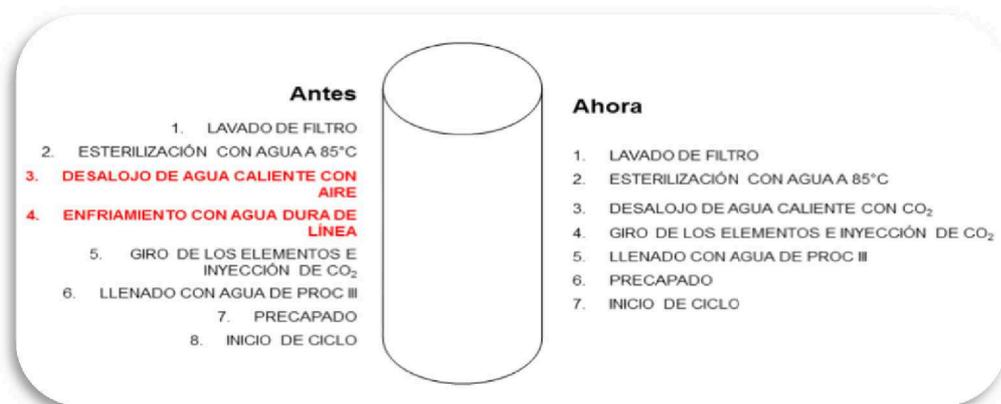
Figura 32. Diagrama preparación del filtro de cerveza.
