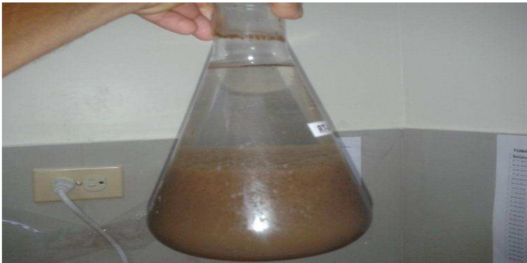
Figura 14. Obtención de lodo biológico activado aireado, floculado para el proceso con los efluentes.
