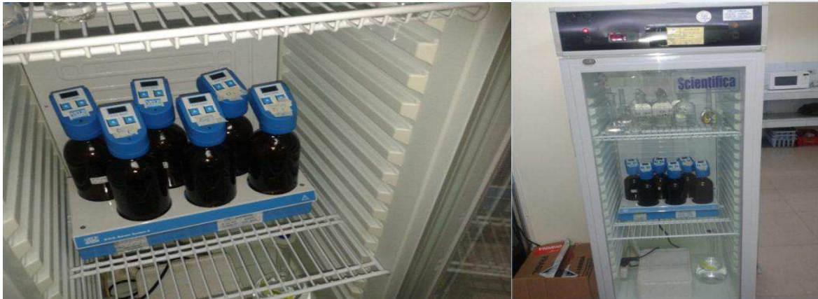
Equipo para la determinación de DBO 5 mediante método respirométrico a 20°C
