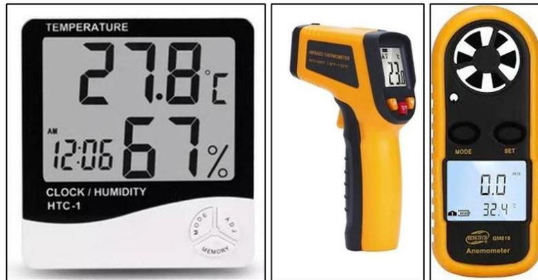
**Figura 10:** Equipos (Izquierda: termohigrómetro digital; en medio: Termómetro infrarrojo industrial; derecha: anemómetro digital)
