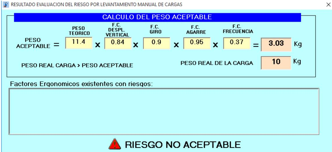
**Figura 25** Proceso de descarga; resultado de la evaluación
