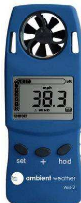
Figura 39: Anemómetro Digital Portable Ambient Weather WM-2. Fuente: Elaboración propia.
