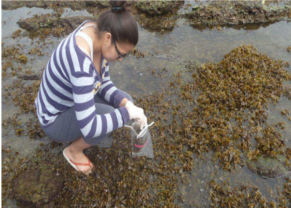
Ilustración 29; Método de colecta de algas para análisis de metales pesados.
