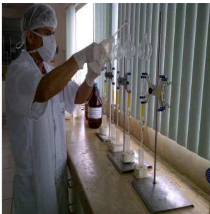
ANEXO 6.- Anadir 10 ml de agua destilada y abrir la llave de la columna para permitir que se filtre el destilado. Cuidar que no se seque la resina
