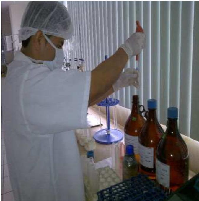
ANEXO 8.- Adicionar 3 ml de hidróxido de sodio 1N y agite. Adicionar 3 ml de ácido fosfórico 3,57 N y Agicione 1 ml de OPT al 0,1% y agite
