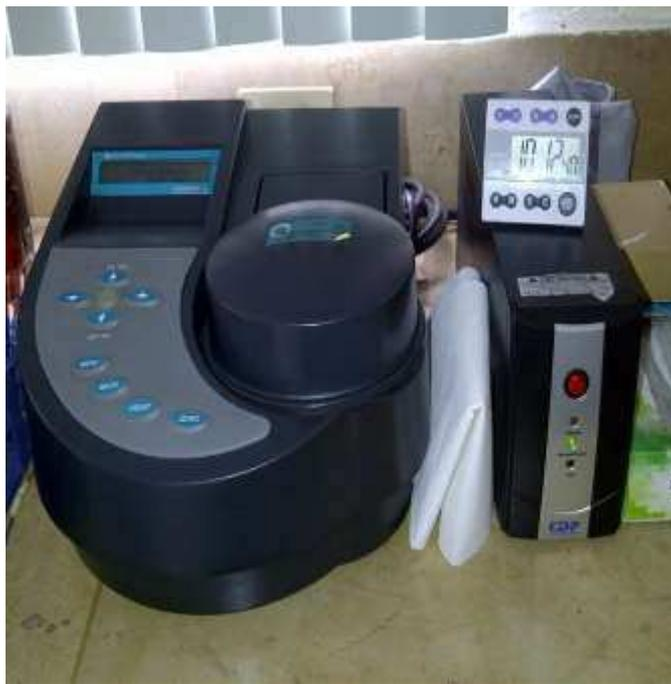
ANEXO 10.- Colocar en el tubo del fluorómetro, proceder a leer y calcular el contenido de histamina, sin desechar el contenido del tubo de ensa
