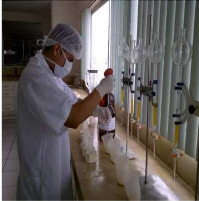
ANEXO 7.- Tomar del filtro 5 ml y transferirlo a un tubo de ensayo, adicionar 10 ml de ácido clorhídrico 0,1 N y agitarlo.
