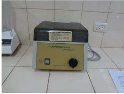
**Figura# 7** El equipo que se utilizó la centrifuga
