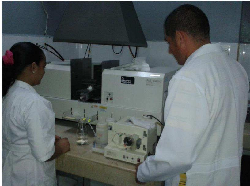
Anexo # 1.- Colocación de muestras en espectrofotómetro de absorción atómica, para determinación de Mercurio. Fuente: Autores de tesis.
