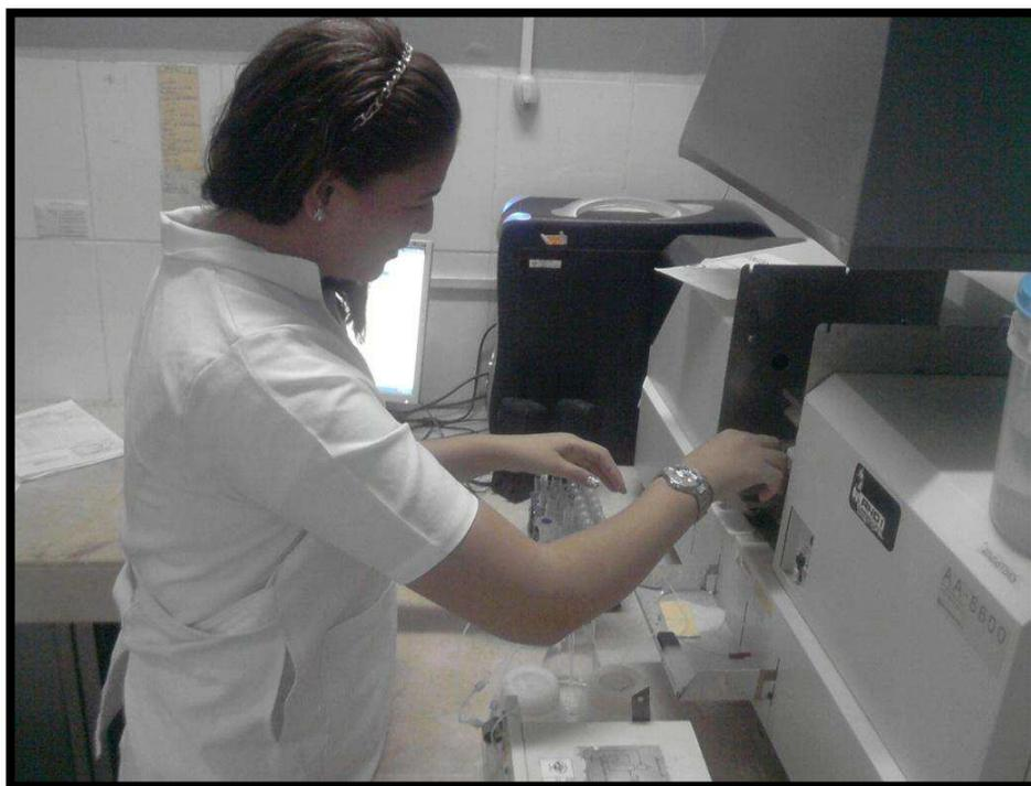
Anexo # 4.- Análisis con espectrofotómetro de absorción atómica de muestras de atún Skip Jack, para determinación de plomo.
