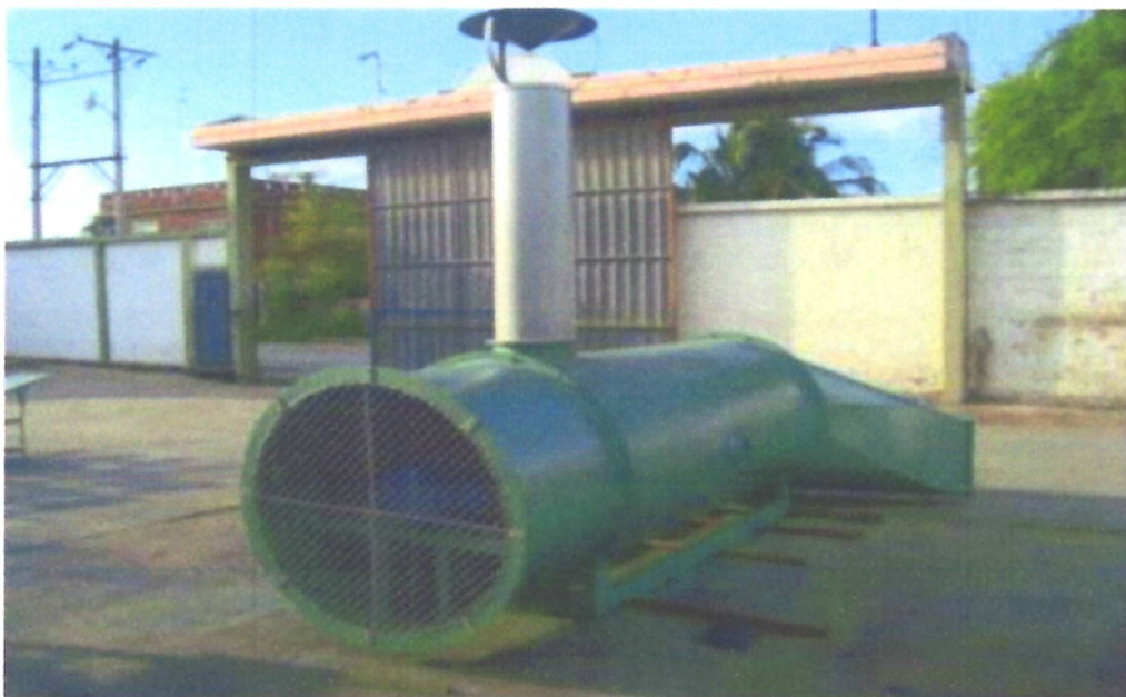
SISTEMA DE QUEMADOR CON INTERCAMBIADOR DE CALOR
