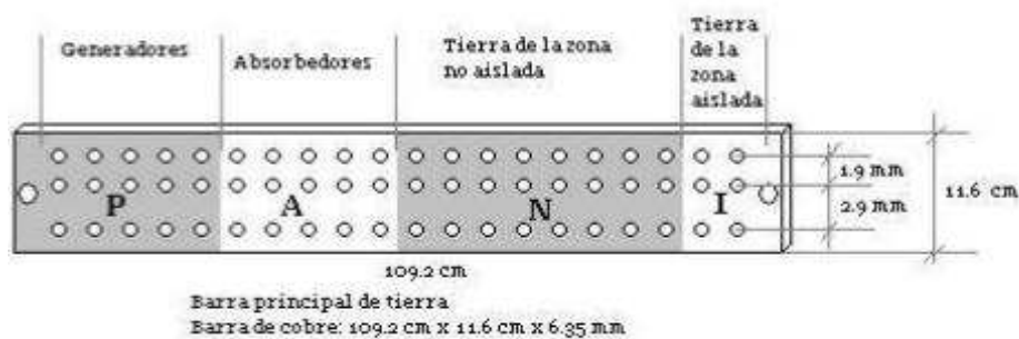
Figura 11: Barra principal de tierra.
