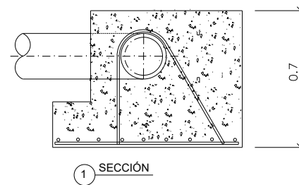
ANCLAJE DE PIEZA EN T REDUCTORA 160mm a 63mm
