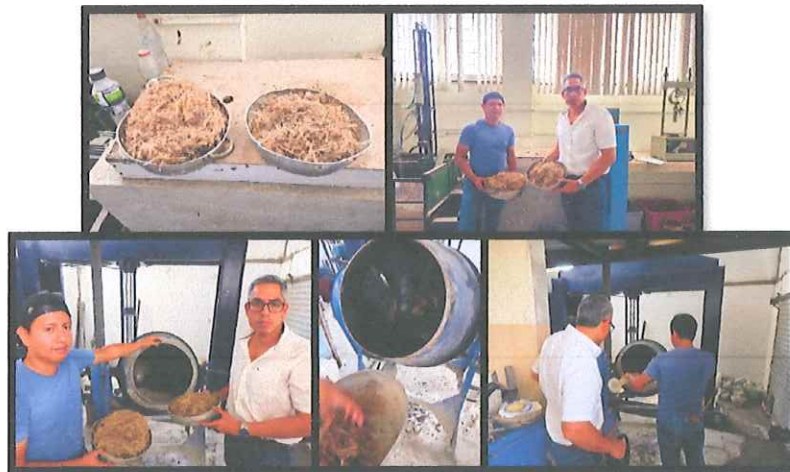
Anexo 3 Supervisión e inclusión de fibras al hormigón.
