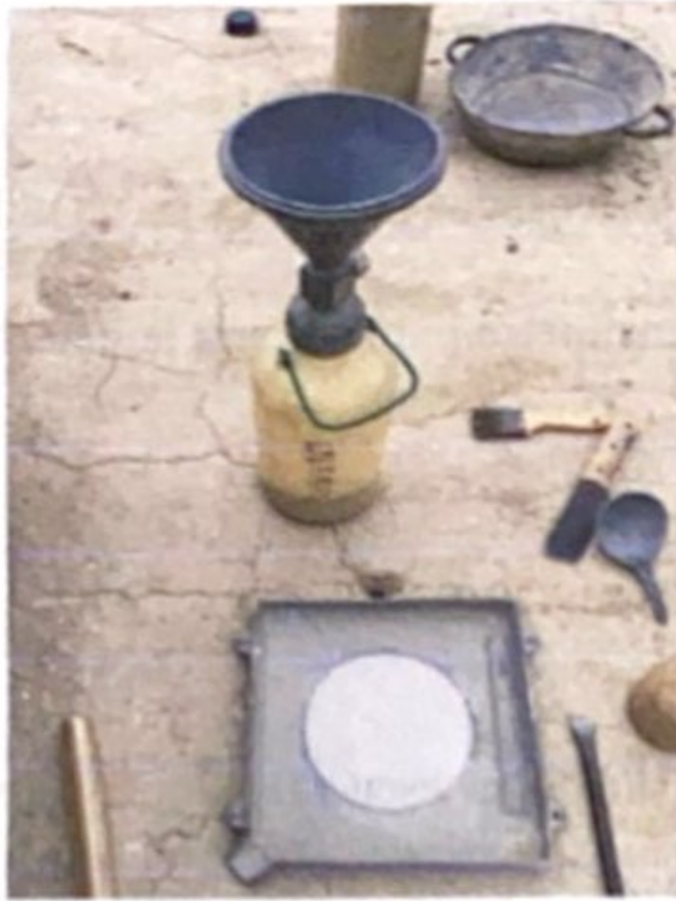
Ilustración 14. Ensayo de Cono y Arena (Ottawa)
