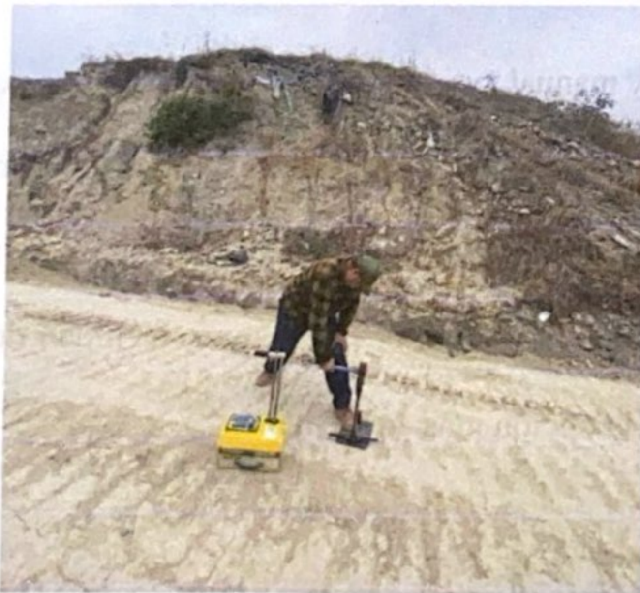
Ilustración 16. Perforación con la varilla.
