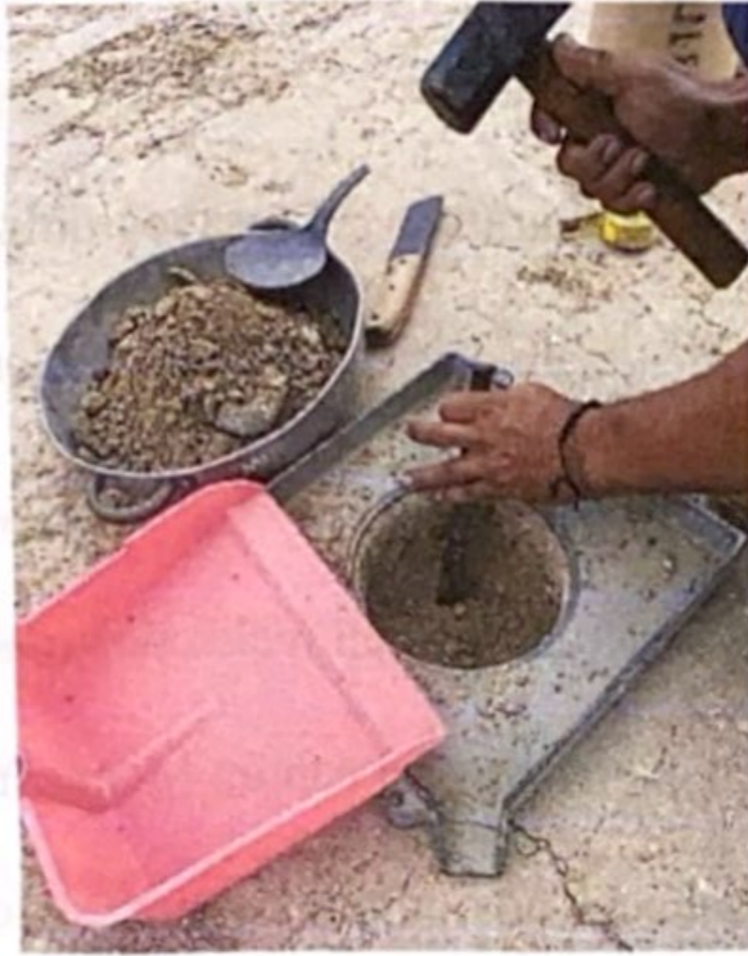
Ilustración 9. Realización del Hoyo con cincel y martillo.
