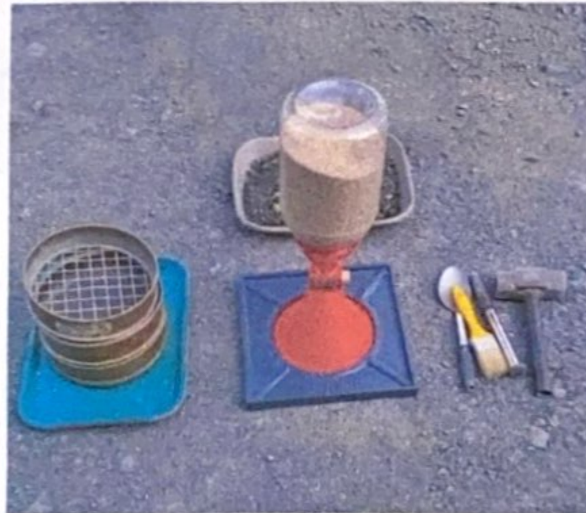
Figura 4. Prueba de Cono y Arena
