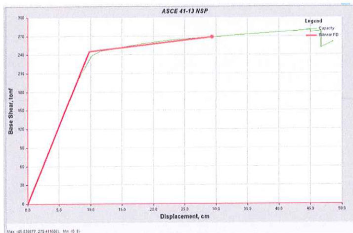
Figura 6-28. Punto de desempeño modelo irregular #3 en dirección Y, ante la acción del sismo raro.
