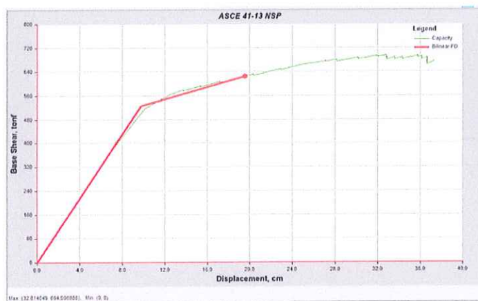
Figura 6-15. Punto de desempeño modelo irregular #1 en dirección Y, ante la acción del sismo ocasional.
