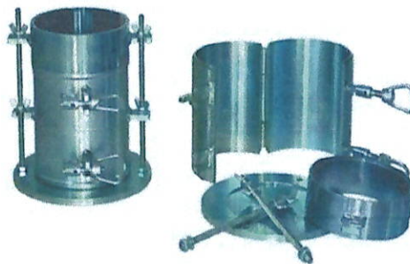
Figura 5.- Molde de método Marshall
