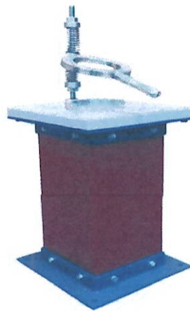
Figura 7.- Pedestal de compactación de método Marshall.
