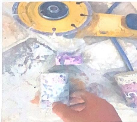
*Figura 54 Corte de Testigos para relación 1:2*
