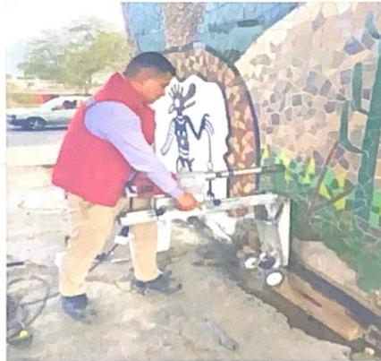
*Figura 32 Ensayo Diamantina*
