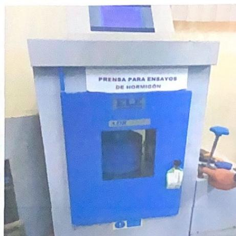
*Figura 45 Prensa Ensayo a Compresión*
