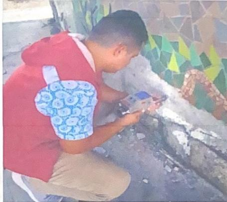
*Figura 25 Ensayo Esclerometría*
