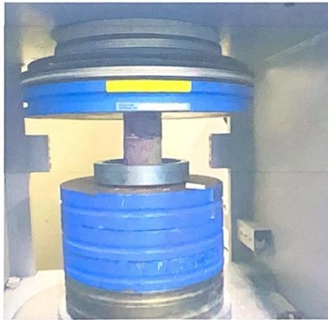
*Figura 47 Ensayo Resistencia a Compresión.*
