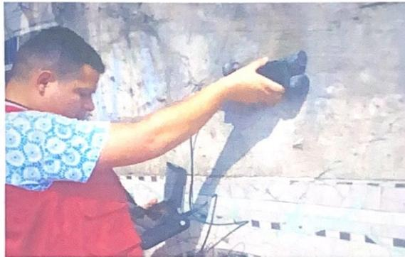
**Figura 9** Ensayo Pachometro Paso a desnivel Tarqui.
