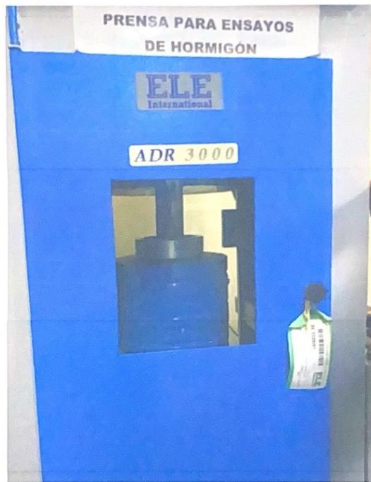
**Figura 15** Ensayo Compresión Prensa Laboratorio de Suelos Carrera de Ingeniería Civil.
