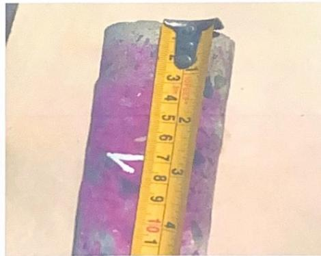
*Figura 17 Ensayo Carbonatación Testigo 1*
