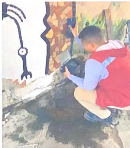
*Figura 36 Pachometría previo a Ensayo*
