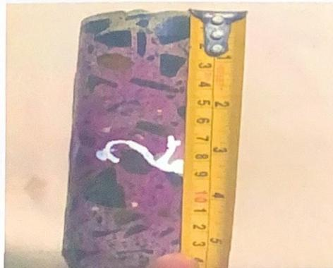
*Figura 18 Ensayo Carbonatación Testigo 2*
