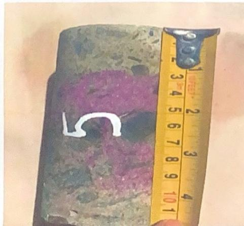
**Figura 21** Ensayo Carbonatación Testigo 5
