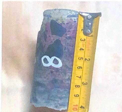
*Figura 24 Ensayo Carbonatación Testigo 8*
