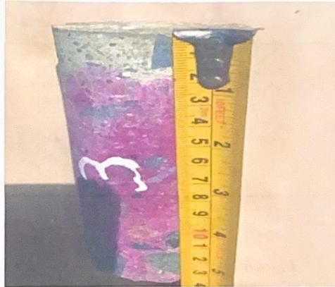
**Figura 19** Ensayo Carbonatación Testigo 3
