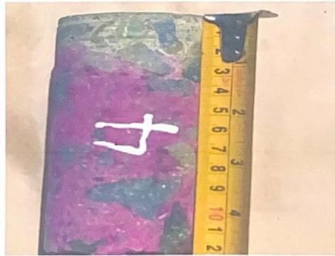
**Figura 20** Ensayo Carbonatación Testigo 4
