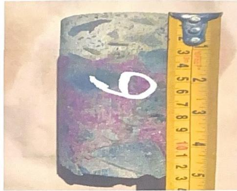
*Figura 22 Ensayo Carbonatación Testigo 6*
