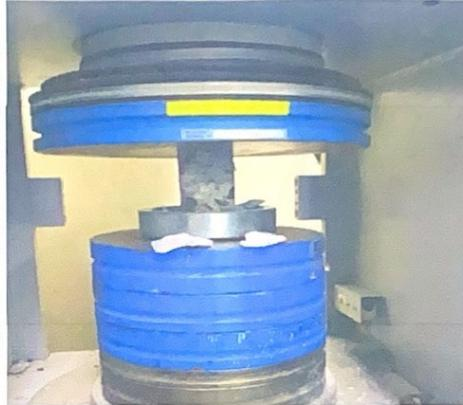
*Figura 46 Ensayo Resistencia a Compresión.*
