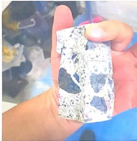
*Figura 50 Testigos ensayados.*
