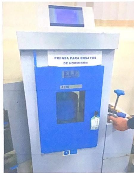
**Figura 11** Prensa para Ensayos de Hormigón Laboratorio de Suelos Uleam.
