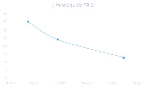
Figura2. Curva de limite líquido de la muestra TR01
