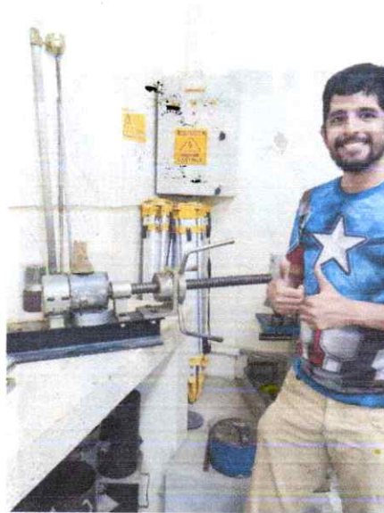
Ilustración34. Desmolde de la muestra en el proctor
