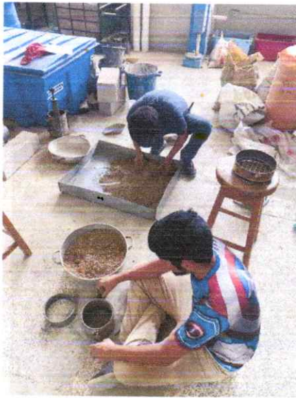
Ilustración33. Preparación de las muestras para el ensayo de proctor
