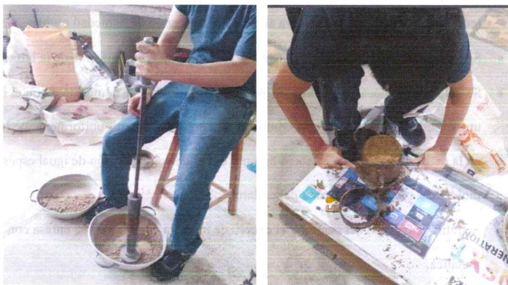
Ilustración23. Triturando material para el ensayo de CBR
