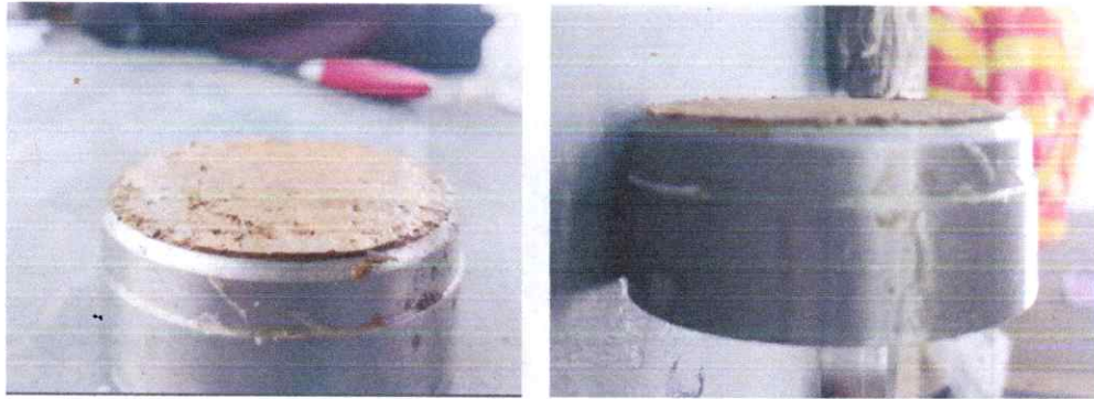
Ilustración 27. Pasada las 24 horas se remueven las muestras del consolidometro, y se pasan las muestras a una bandeja para pesarlas y meterlas al horno
