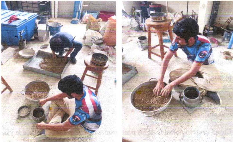
Ilustración22. Con el material pasado de tamiz \frac{3}{4} se procede a amasar de acuerdo a las humedades especificadas para obtener la humedad optima.
