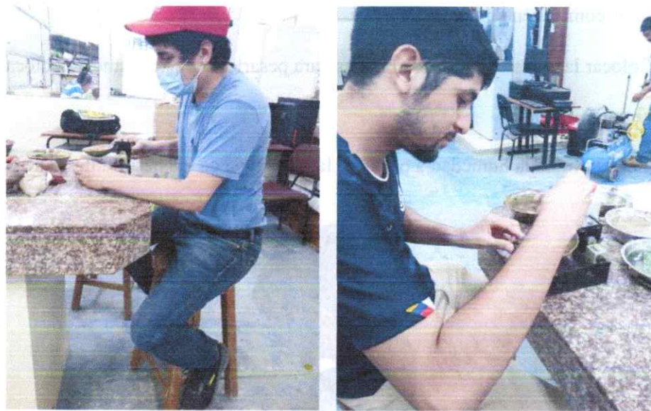
Ilustración 20. Elaboración de las muestras de arcillas por el método de Casagrande
