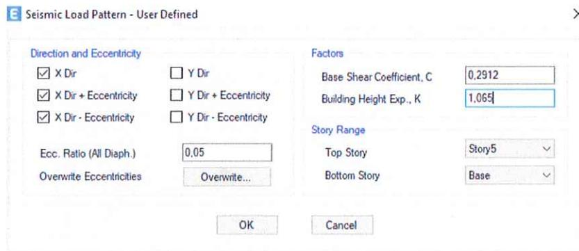
Figura 31. Ingreso de coeficiente C y K respectivamente para el patrón de sismo X.
