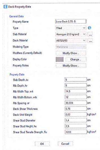
Figura 28. Definición de Losa Deck.
