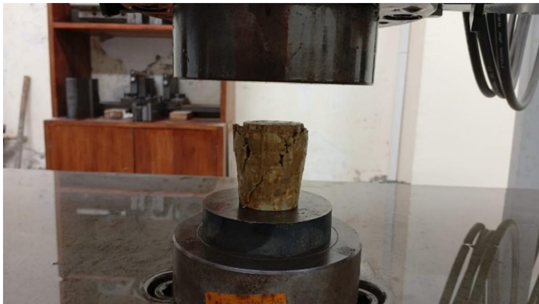
Anexo 10 Ensayo de compresión en Probetas
