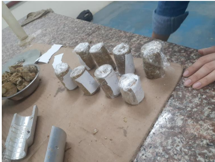
Anexo 11 Probetas con distintas humedades para ensayo con generador de frecuencia y compresión
