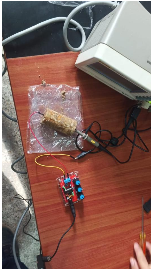
Anexo 13 Ensayo con el generador de frecuencia y osciloscopio
