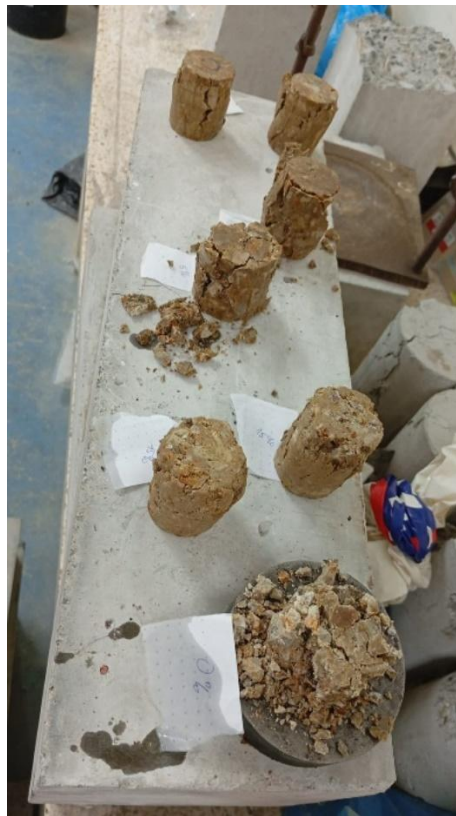
Anexo 12 Probetas ensayadas con distintas humedades
