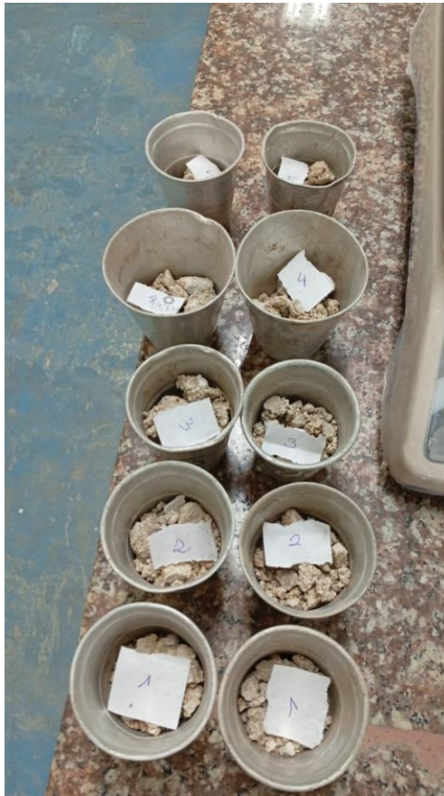
Anexo 9 Muestras del ensayo de Proctor con distintas humedades
