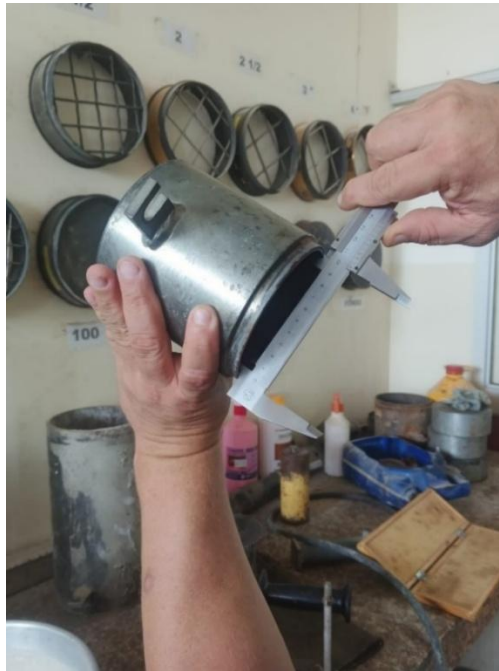
Anexo 7 Molde del ensayo de Proctor
