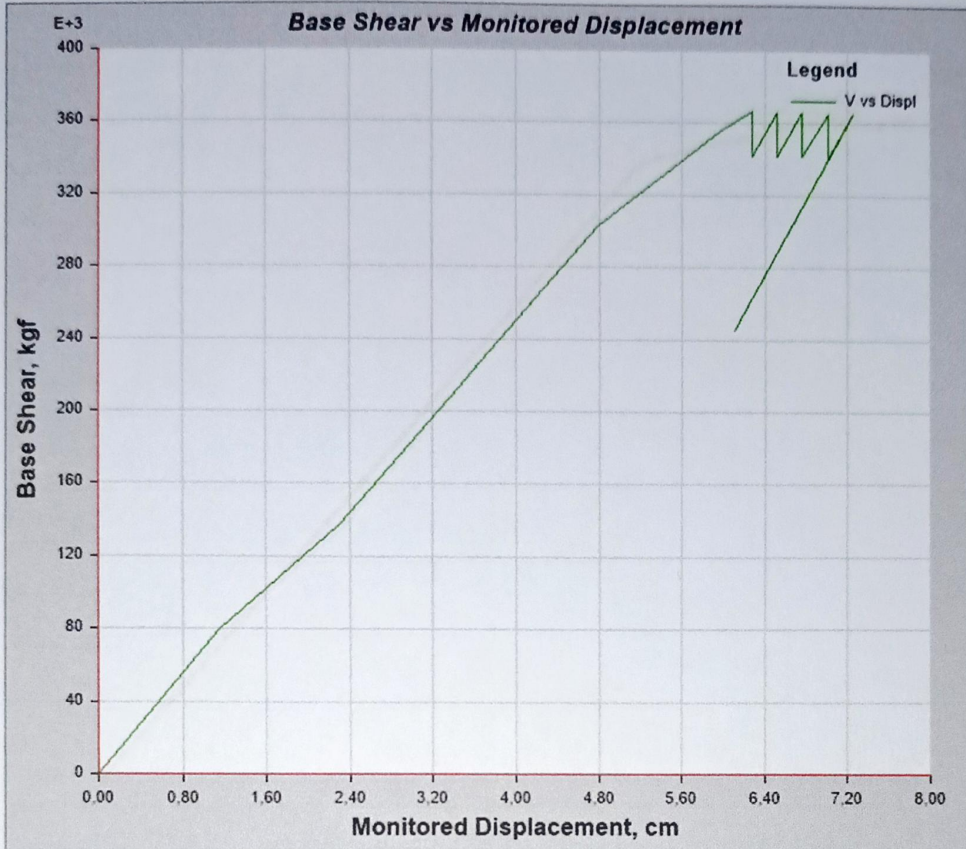
Figura 28. Curva Corte basal vs Desplazamiento en el tope para el modelo en la dirección X
