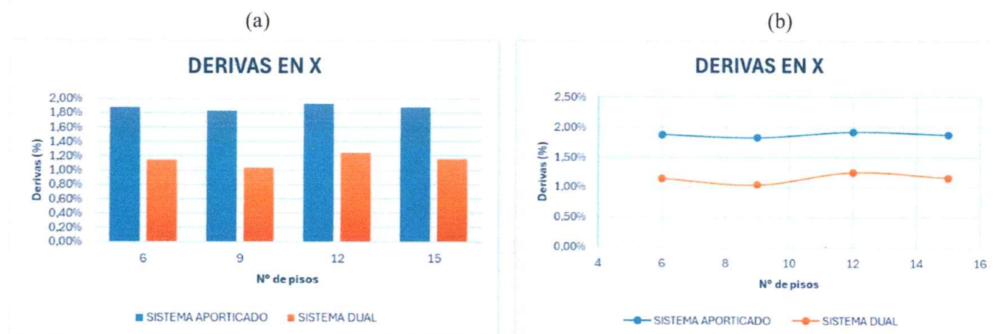
Figura 19. Gráficas comparativas de las derivas en el eje X en ambos sistemas.
