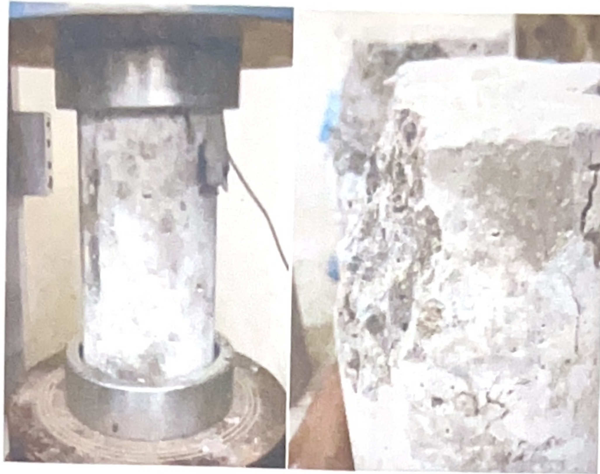
Figura 10 Ruptura de probetas con añadido al 4% luego de ensayos
