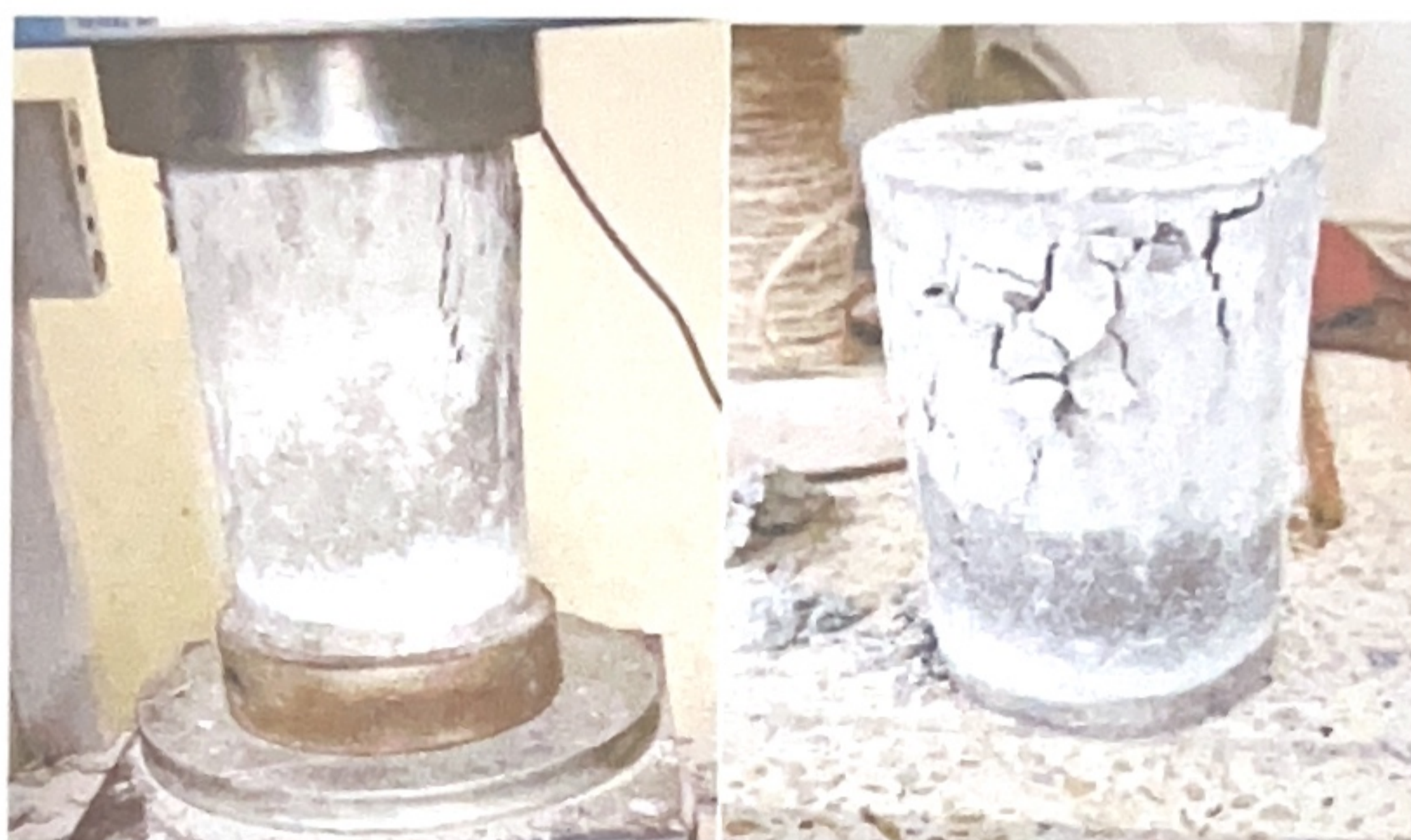
Figura 9 Ruptura de probetas con añadido al 2% luego de ensayos
