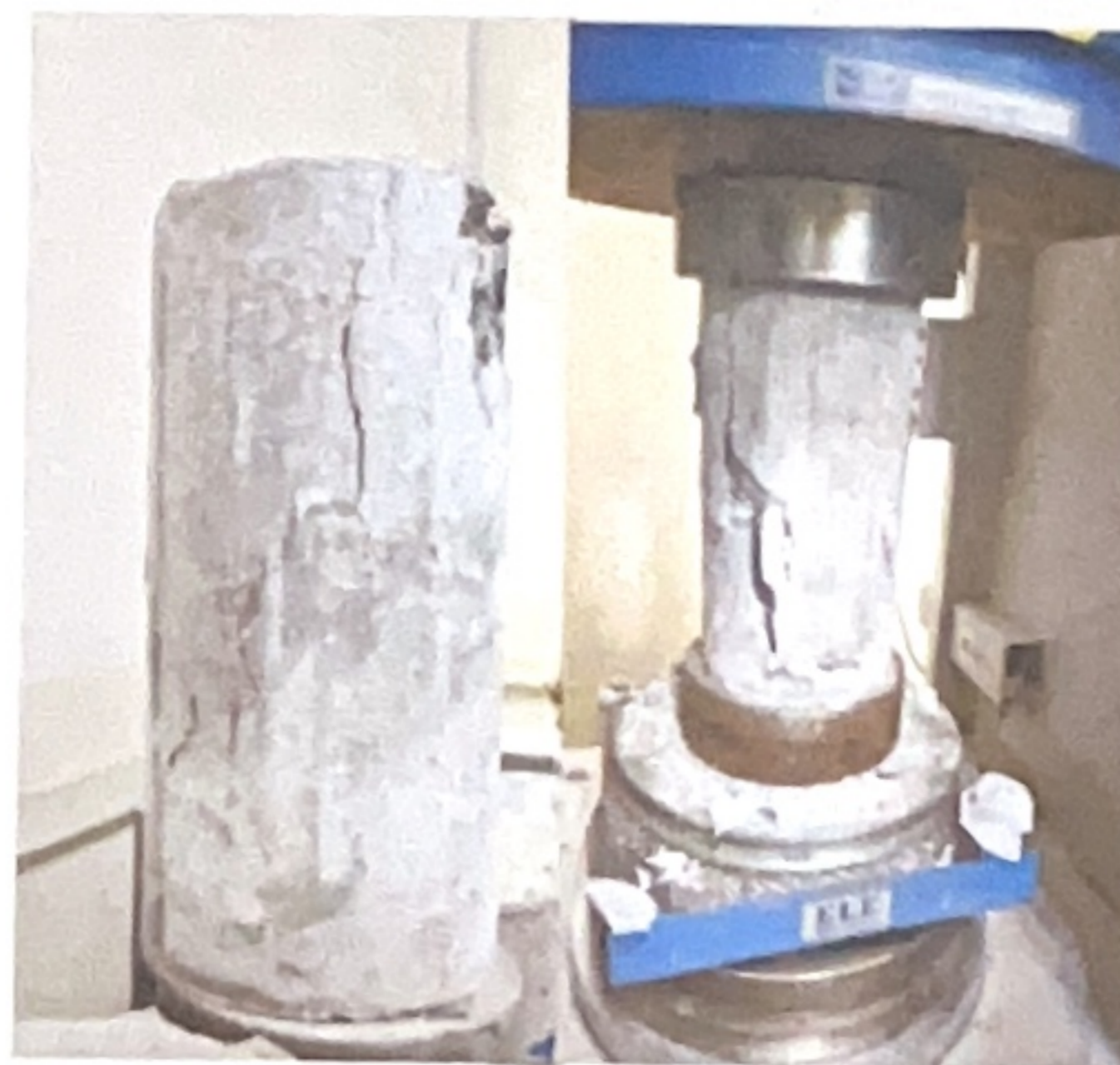
Figura 8 Ruptura de probetas sin añadido luego de ensayos
