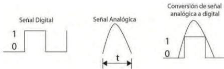
Ilustración 4 Tipos de señales que acepta un PLC.
