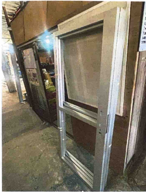
Figura No. 11. Puerta realizada con las medidas y dimensiones de la cerradura inteligente
