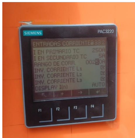
Figura 21: Configuración del SENTRON PAC 3220.
