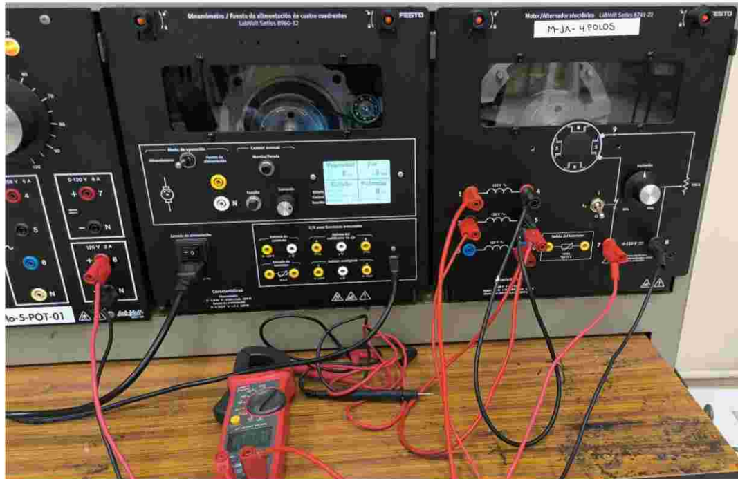
Conexión de equipos e instrumentación para práctica de turbina hidroeléctrica en vacío
