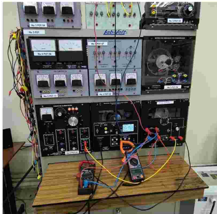
Conexión de equipos e instrumentación para práctica de banco de inductancias
