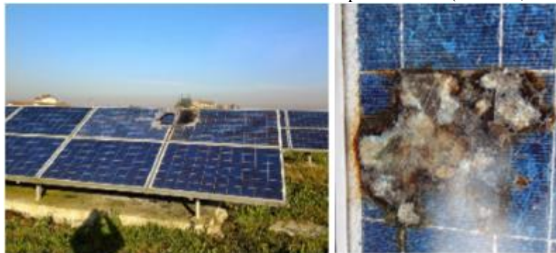
Ilustración 8 Paneles sobrecalentados, por el efecto sombra.
