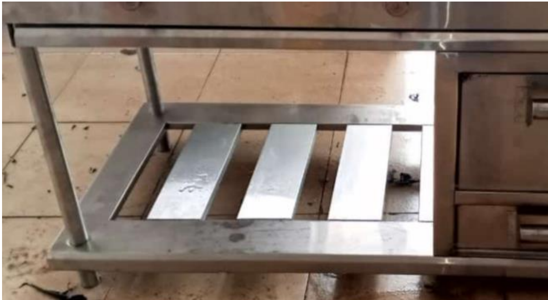
Ilustración 6: Entrepañó elaborado en plancha de acero de 1 mm de espesor
