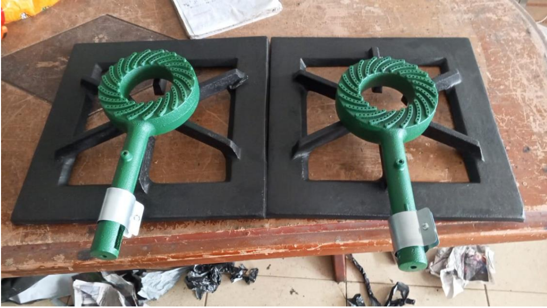
Ilustración 3: Quemadores de 13.000 - 15.000 BTU
