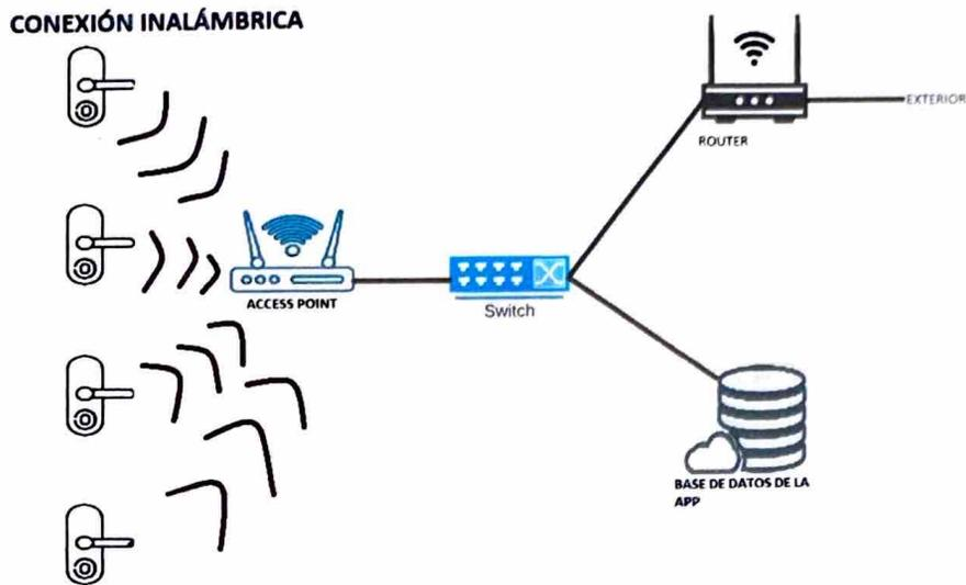
*Figura No 15 Conexión Inalámbrica*
