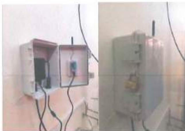
*Nota. Servidor Instalado con Cable LAN y Microcontrolador Esp32 para obtener datos del Nodo.*
