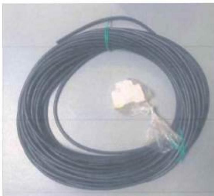
*Nota. Cable concéntrico para ingreso de energía al circuito eléctrico.*
