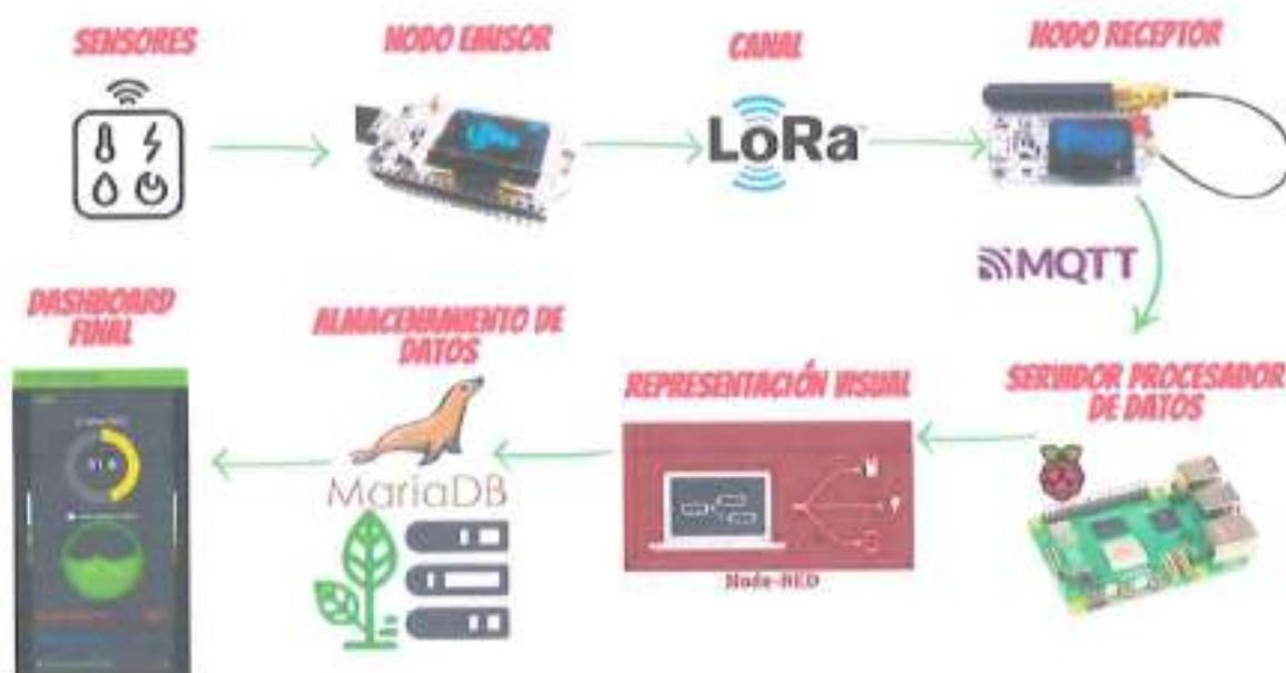
*Ilustración 2. Diseño de la estructura para el funcionamiento y comunicación del servidor para riego automatizado.*
