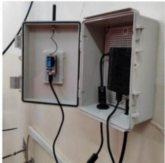
*Ilustración 94. Tablero y servidor del riego*
