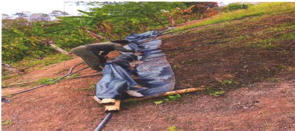
Anexo 8. Implementacion del insumo (plástico) para aplicar el método de recolectores de erosión.
