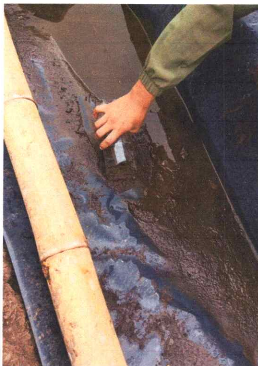
Anexo 9. Recolección de suelo para medir la cantidad de perdida de suelo en la pendiente.
