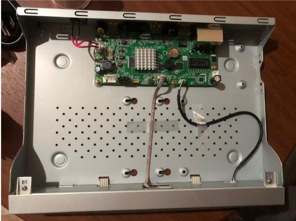
*Ilustración 30 NVR Híbrido componentes internos*
