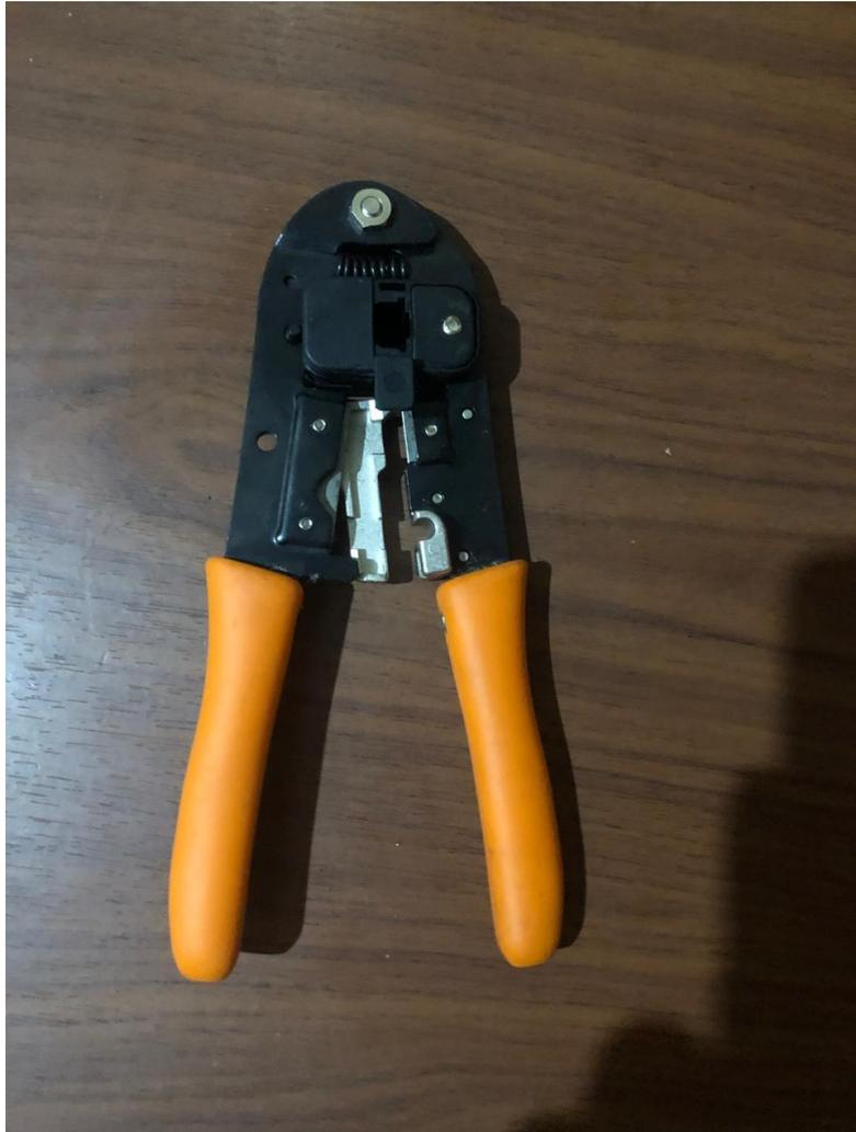
*Ilustración 16 Herramienta de Crimpado (Ponchadora)*
