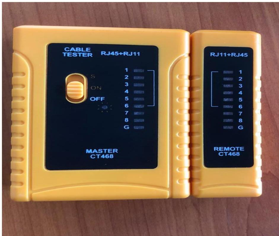
*Ilustración 17 Herramienta de verificación, probador de cables*
