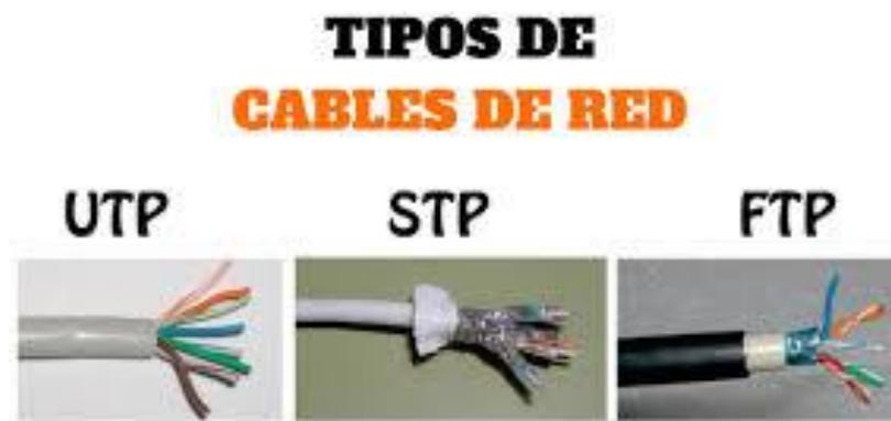
*Ilustración 2 Tipos de cables de Red*
