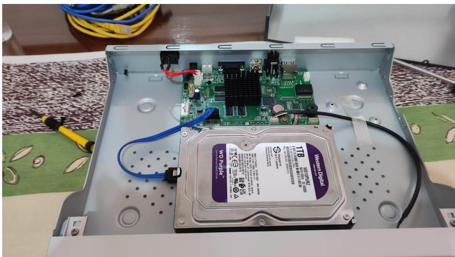
*Ilustración 19: Instalación del disco duro en el NVR*
