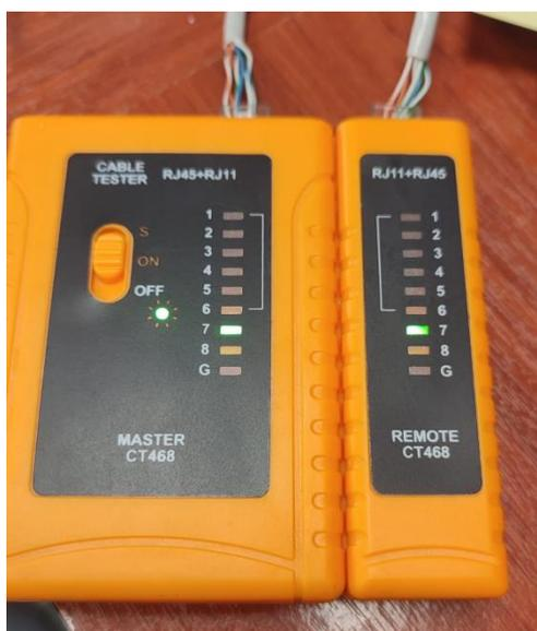
*Ilustración 18: Verificación de los cables con el tester*
