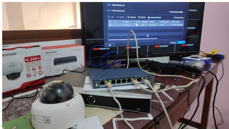
*Ilustración 21: Configuración de las cámaras con el NVR*
