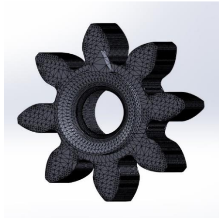
Ilustración 1. Modelo de engranaje hecho en SolidWorks.
