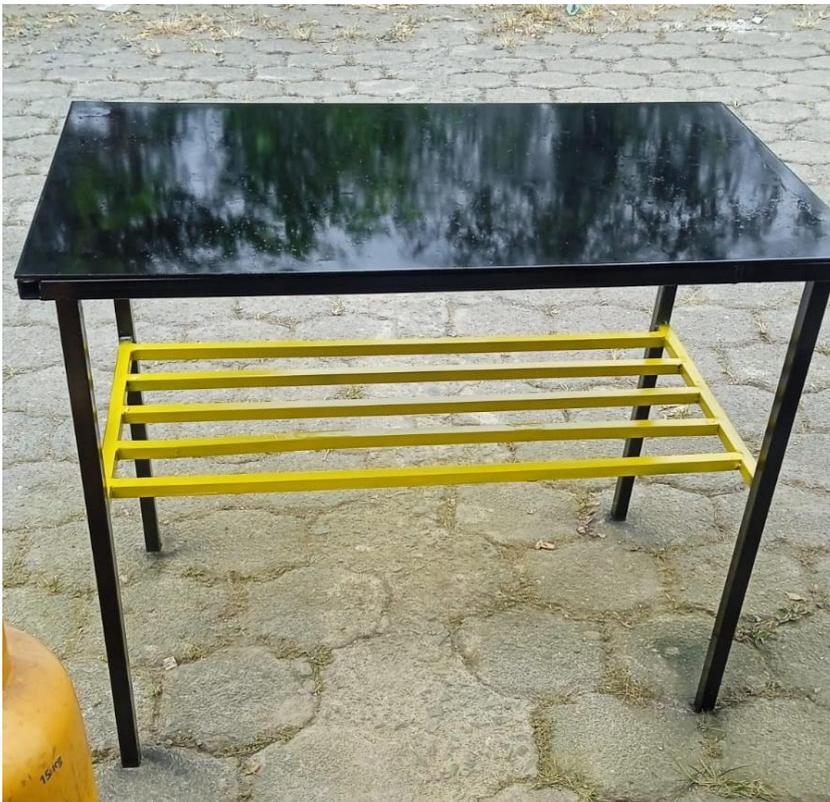
*Ilustración 4 mesa de soldadura MIG culminada*
