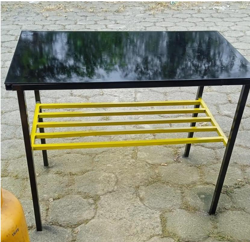
*Ilustración 7 mesa de soldadura MIG culminada*
