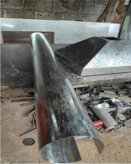
**Ilustración 12:** Construcción de un tubo tipo ducto
