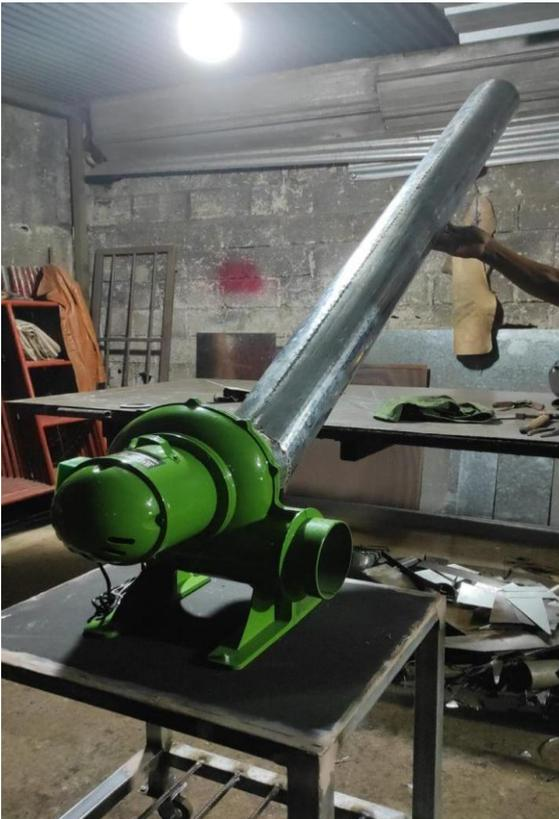
**Ilustración 13:** Instalación del tubo con extractor
