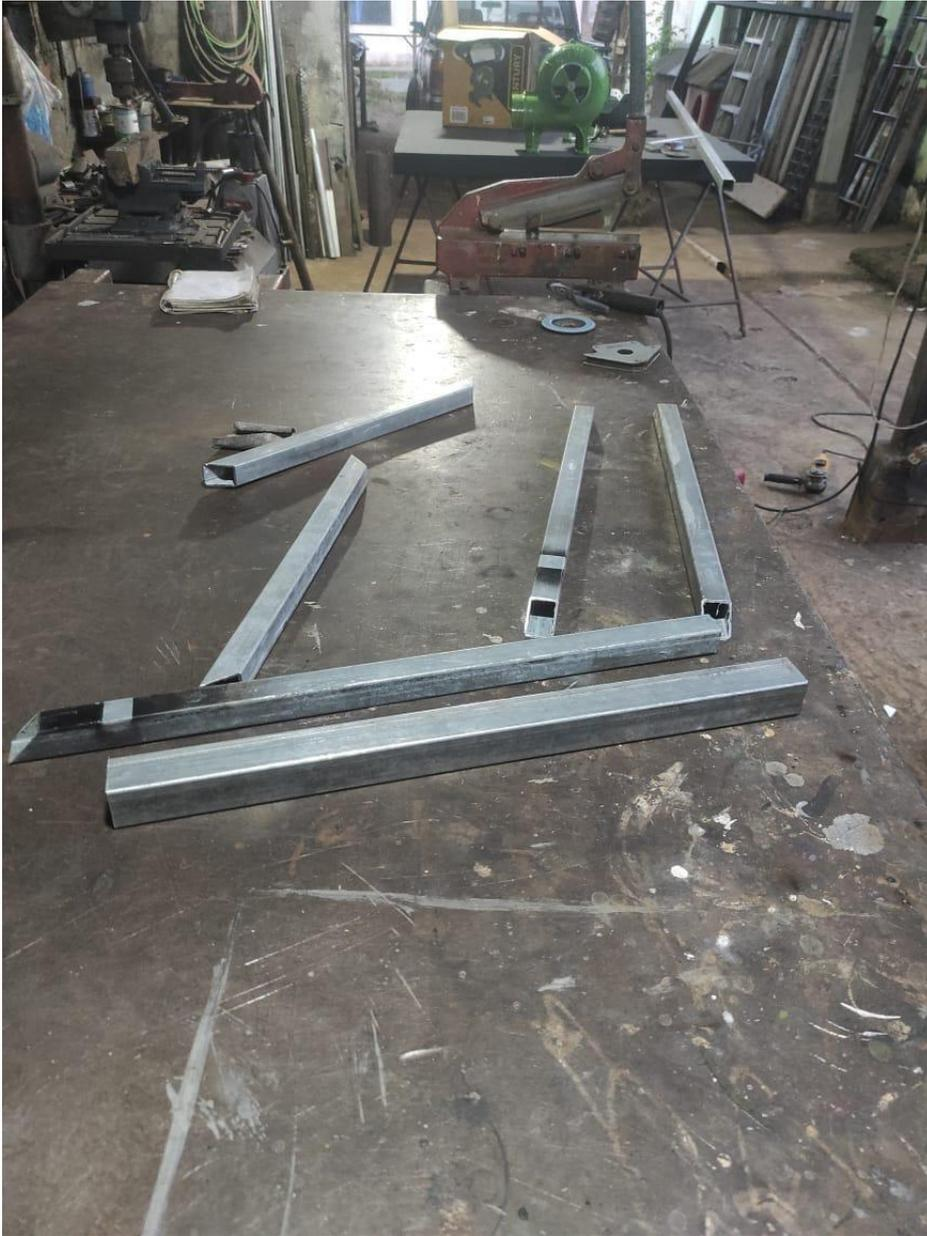
**Ilustración 9:** Construcción de la mesa de soporte del extractor
