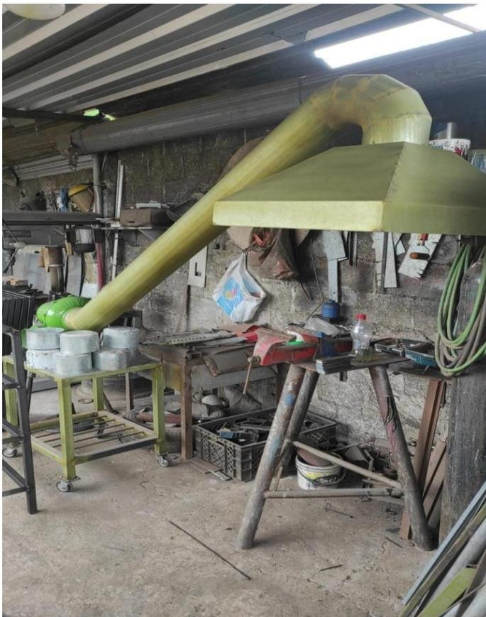
**Ilustración 15:** Se finalizó soldando una varilla para darle soporte al sistema
