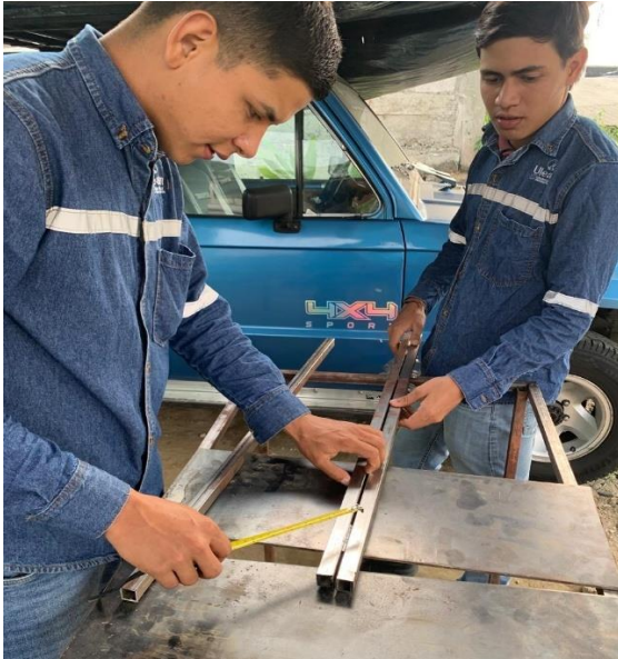
Ilustración 6 medidas para el marco del banco
