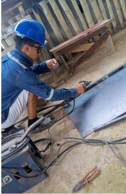
*Ilustración 5 Proceso de soldadura para la estructura de la base*
