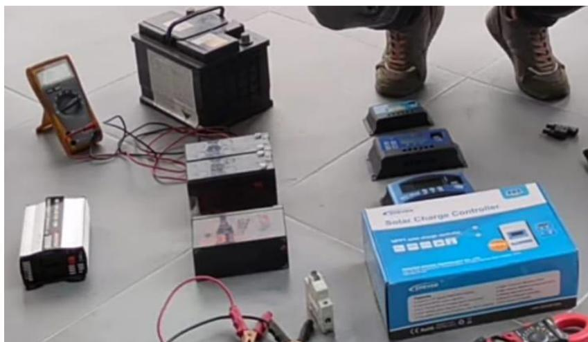
*Ilustración 2 elementos obtenidos para poder generar la carga necesaria*
