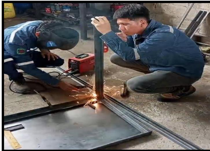
*Figura 3.8:* Ensamblaje de los soportes del banco de soldadura.
