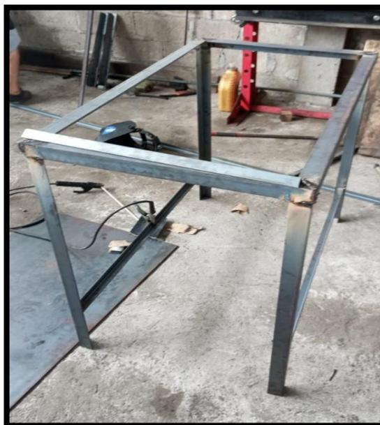
*Figura 3.9:* Estructura del banco de soldadura finalizado.
