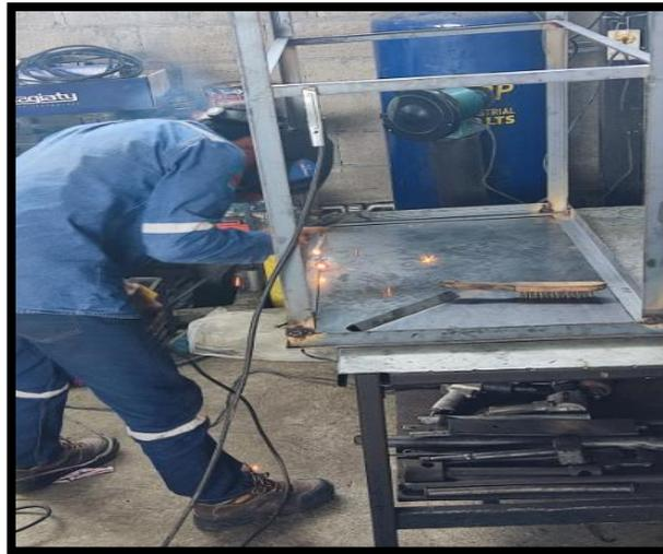
*Figura 3.10:* Ensamblaje de la plancha de tol de 5 milímetros a la estructura del banco de soldadura MIG.
