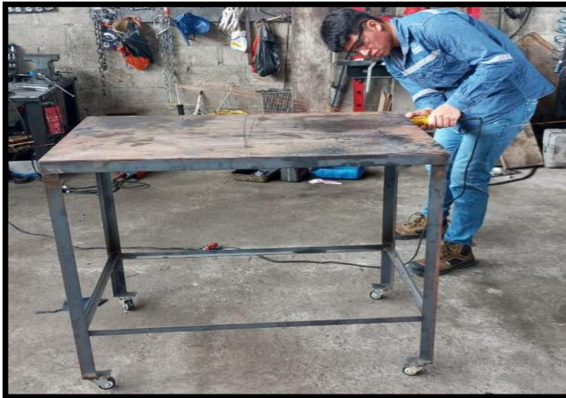
*Figura 3.12:* Corrección de imperfecciones del banco de soldadura MIG.
