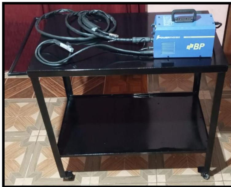
*Figura 3.18:* Banco de soldadura MIG con su equipo de soldadura.
