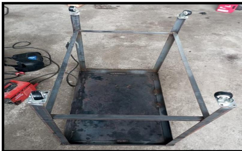
*Figura 3.11:* Ensamble del sistema de movilidad con ruedas del banco de soldadura.
