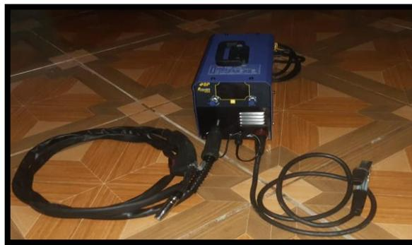
*Figura 3.4:* Equipo de soldadura MIG.
