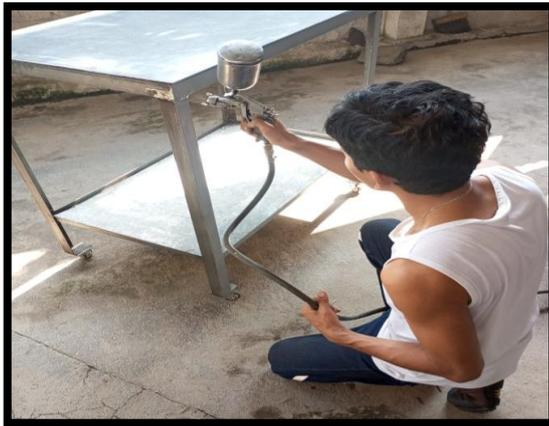
*Figura 3.14:* Proceso de fondeado del banco de soldadura MIG.
