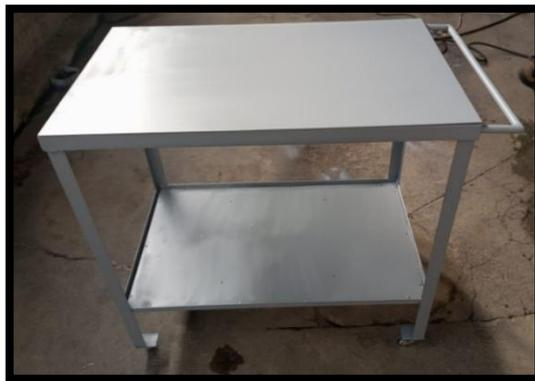
*Figura 3.15:* Banco de soldadura MIG fondeado listo para ser pintado.
