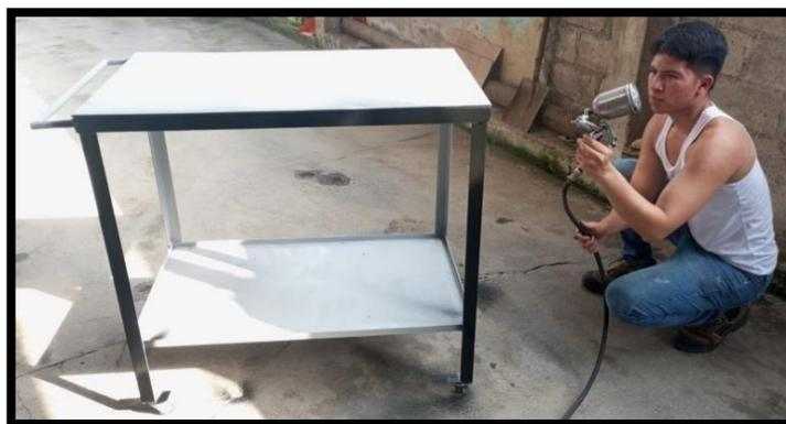
*Figura 3.16:* Proceso de pintado del banco de soldadura MIG.
