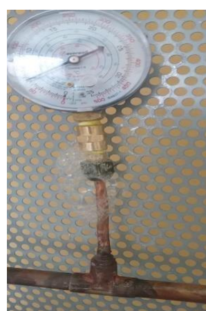
Ilustración 44 Prueba fuga en reloj baja presión
