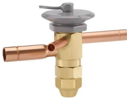
Ilustración 6 Válvula expansión Sporlan gas R-410 con igualador externo 2 toneladas (MONTERREY, CLIMAS, 2023)
