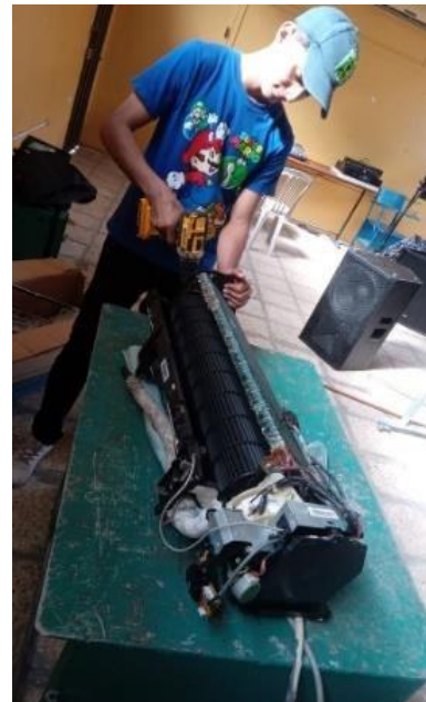
Ilustración 33 Desmontaje de motor unidad evaporadora
