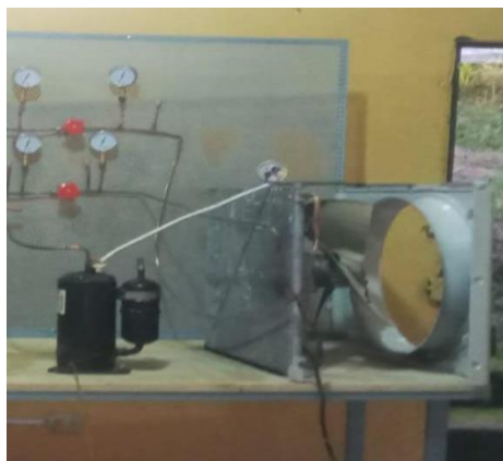
Ilustración 42 Conexión eléctrica compresor
