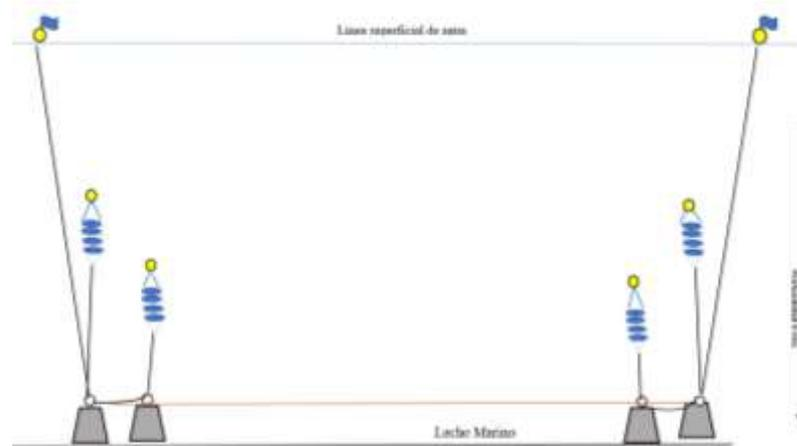
**Figura 6.** Sistema de fondeo y colocación de las linternas chinas a dos profundidades en el cultivo e *M. gigas* en la playa Balsamaragua de Jaramijó.
