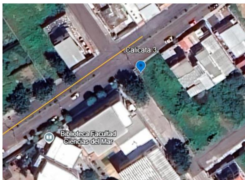
Calicatas 2 y 3: Por la imposibilidad de realizar excavaciones directamente sobre la calzada pavimentada en uso, se seleccionaron dos puntos alternativos. Estos se ubicaron en un terreno natural no intervenido, adyacente al derecho de vía de la Calle Universidad 8.
