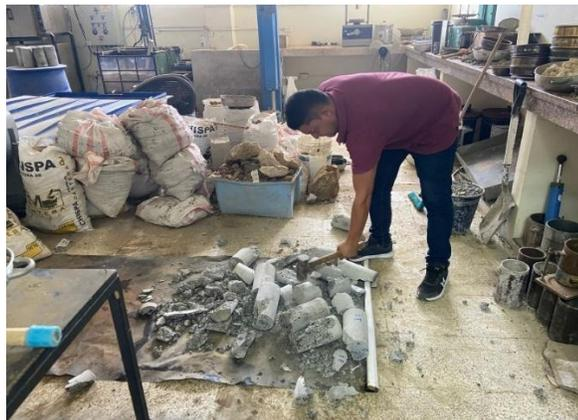
**Figura 2.** Triturado y demolición manual de cilindros de hormigón
