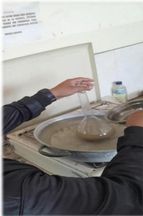
**Figura 6.** Ensayo de gravedad específica de la arena.
