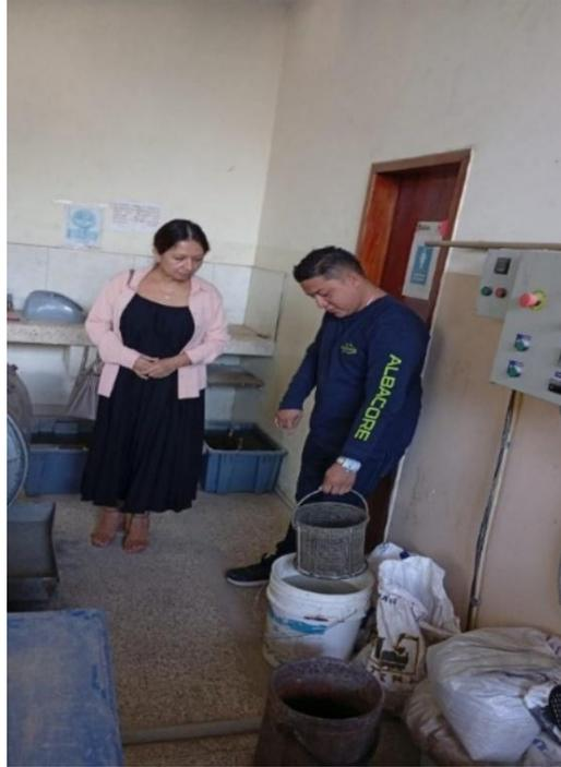
**Figura 7.**Ensayo de peso específico agregado grueso reciclado.
