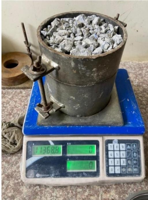
**Figura 10.** Ensayo de peso unitario del agregado.
