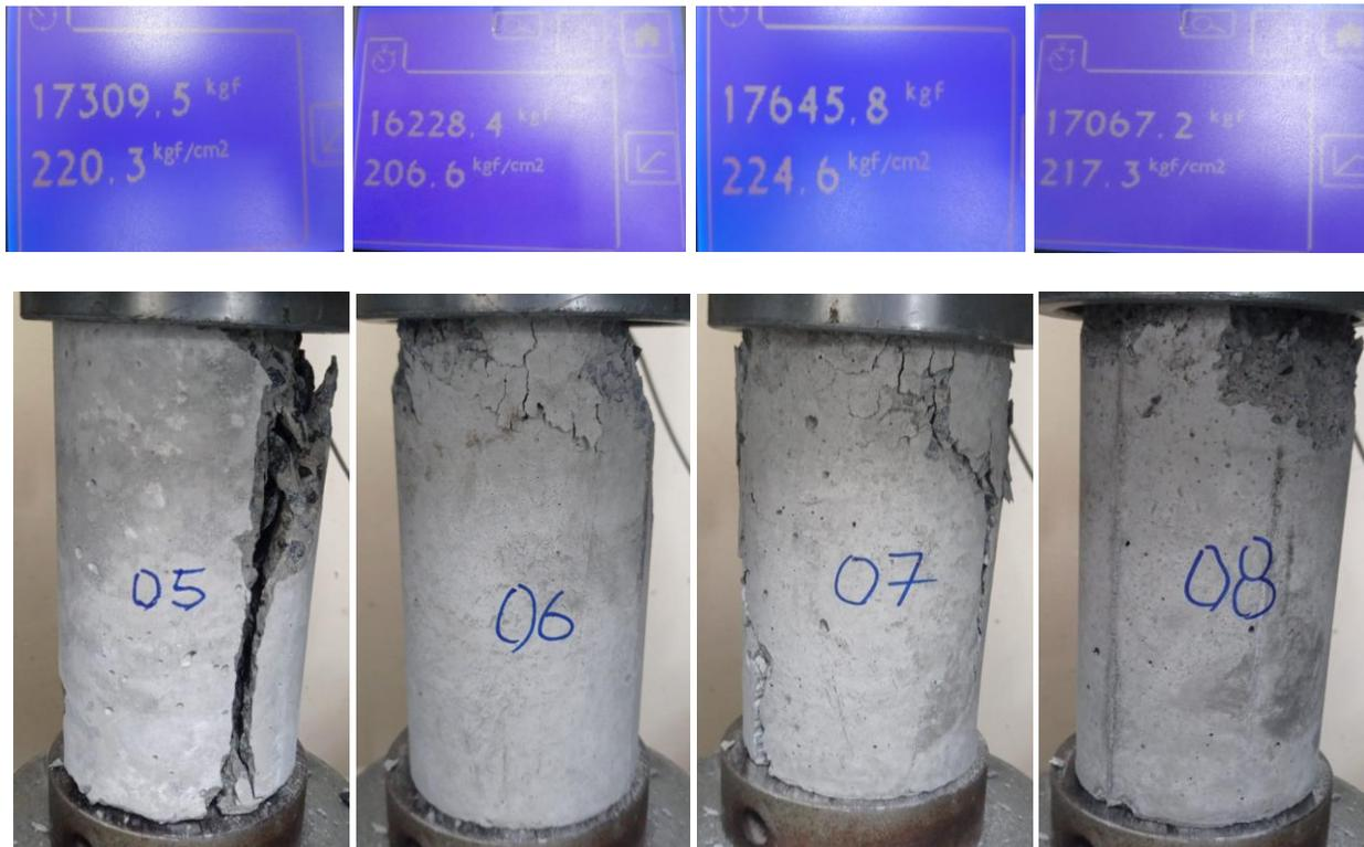
**Figura 22.** Ensayo de su resistencia a los 7 días.
