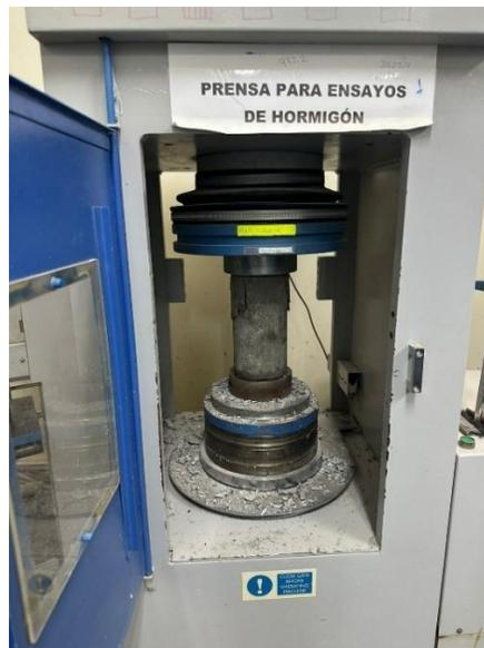
**Figura 19.** Ensayo de resistencia a compresión.
