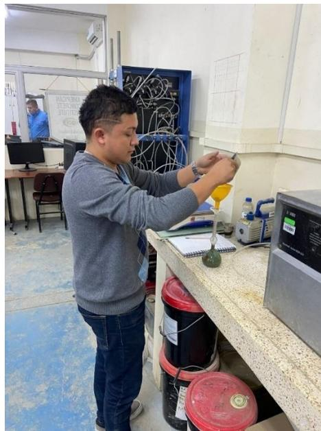
**Figura 11.** Ensayo del peso específico del cemento.
