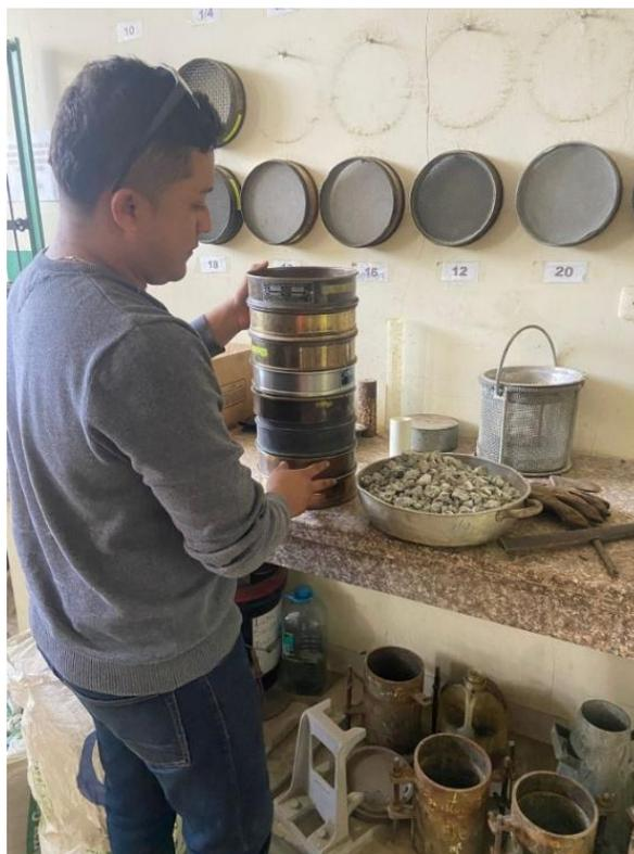
**Figura 5.** Ensayo Granulométrico de agregados
