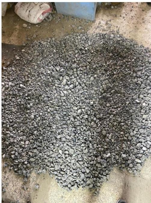
**Figura 4.** Agregado Grueso reciclado.
