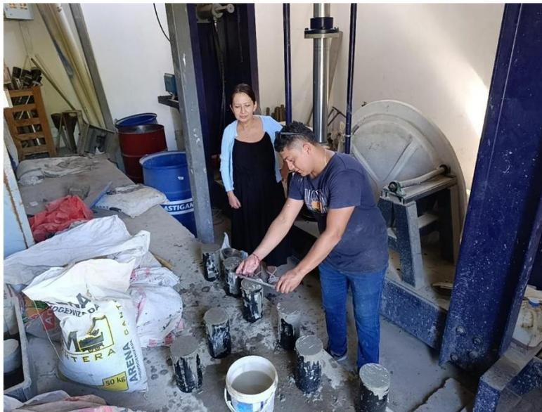
**Figura 17.** Enrasado de cara superior de especímenes.
