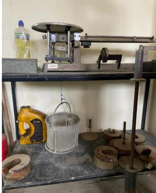
**Figura 9.** Peso de la muestra en el aire.
