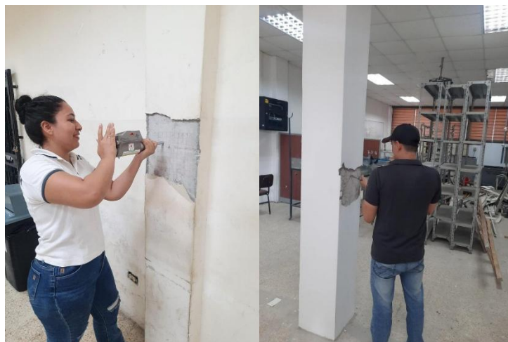
Figura 3.3. Desarrollo del ensato de esclerometría (autor)
