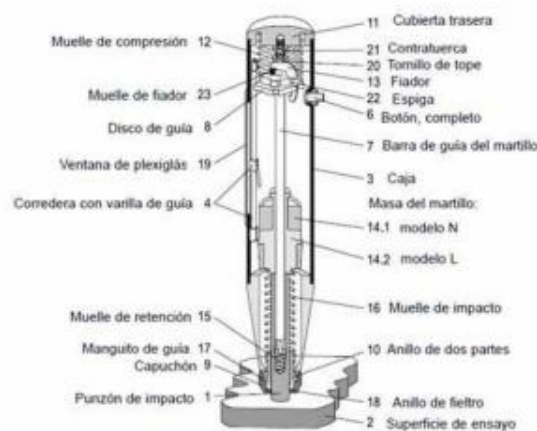
Figura 2.5. Esquema de sección del esclerómetro (Banco de imágenes de google)
