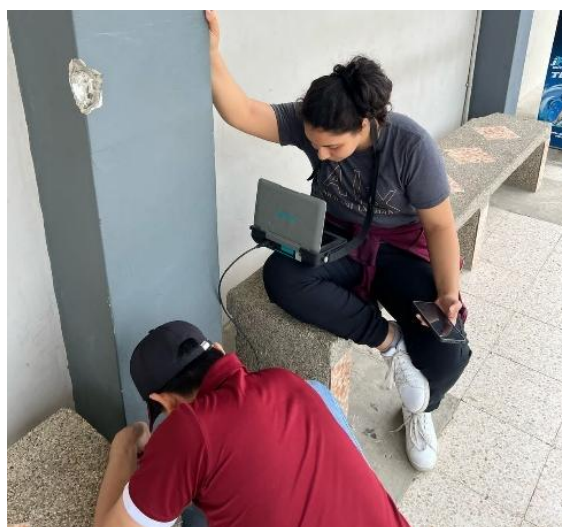
Figura 3.4. Desarrollo del ensayo de pachometría. (Autor)
