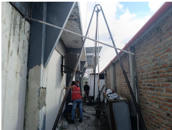
Figura 3.6. Desarrollo del ensayo SPT. (Autor)
