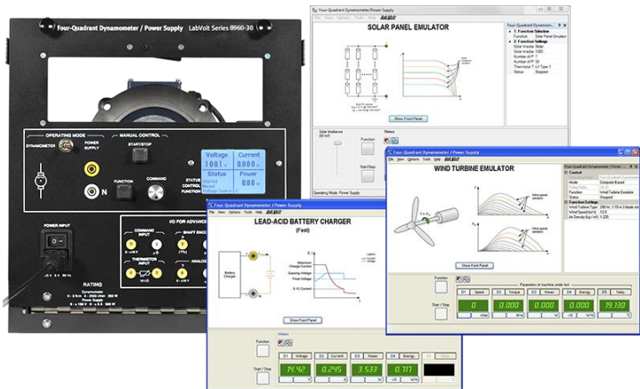
Figura 14 Módulo dinamómetro/fuente de alimentación de cuatro cuadrantes (8960)
